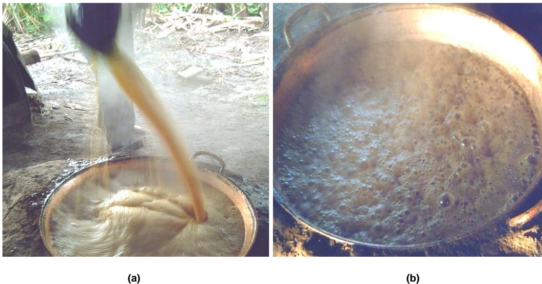
Fig. 1.12 (a) MIEL AGITADA CON TENDENCIA AL DERRAME (b) MIEL EN ESTADO DE CONCENTRACIÓN
