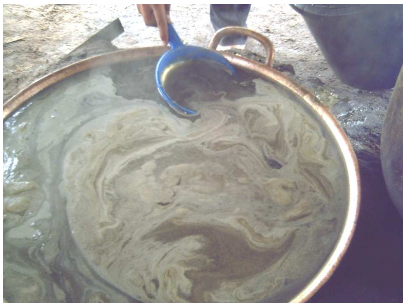
Fig. 1.10 DESCACHAZADO o CLARIFICADO
