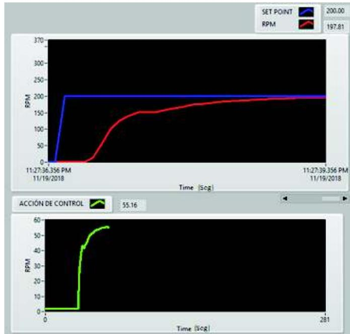
*Figura 3.9 Respuesta del sistema con control PID a un Set de 200 rpm con peso en el eje.*
