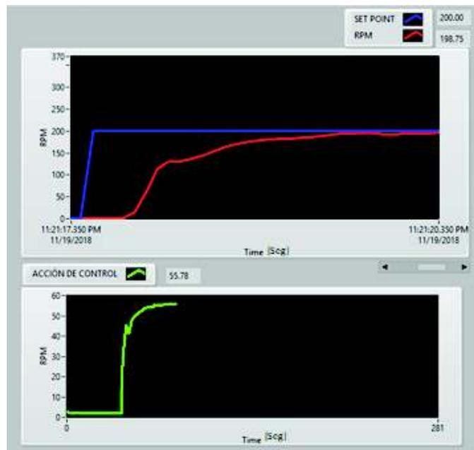
Figura 3.7 Respuesta del sistema con control PID a un Set de 200 rpm.
