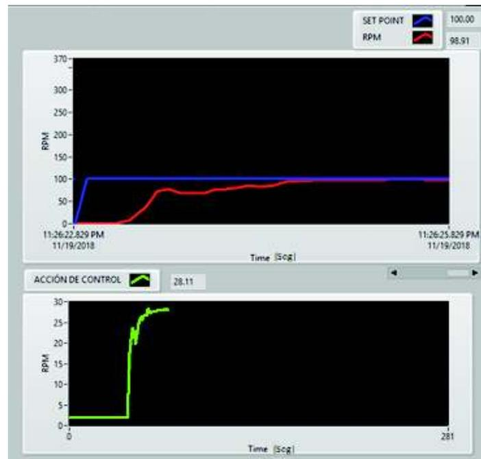
Figura 3.8 Respuesta del sistema con control PID a un Set de 100 rpm con peso en el eje.
