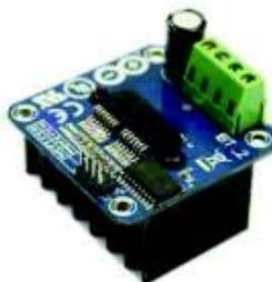
*Figura 2.3 Driver IBT-2 para motores DC.*
