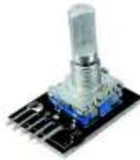
*Figura 1.6 Ejemplo de un encoder incremental de cuadratura.*
