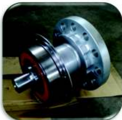
Pieza de la Figura 2.17 finalizada y acoplada al rodamiento de la Figura 2.19
