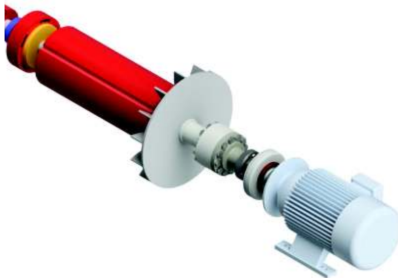
Figura 2.23: Vista isométrica del ensamble del rotor del compensador sincrónico, embrague magnético, eje principal, rodamientos y motor de arranque.
