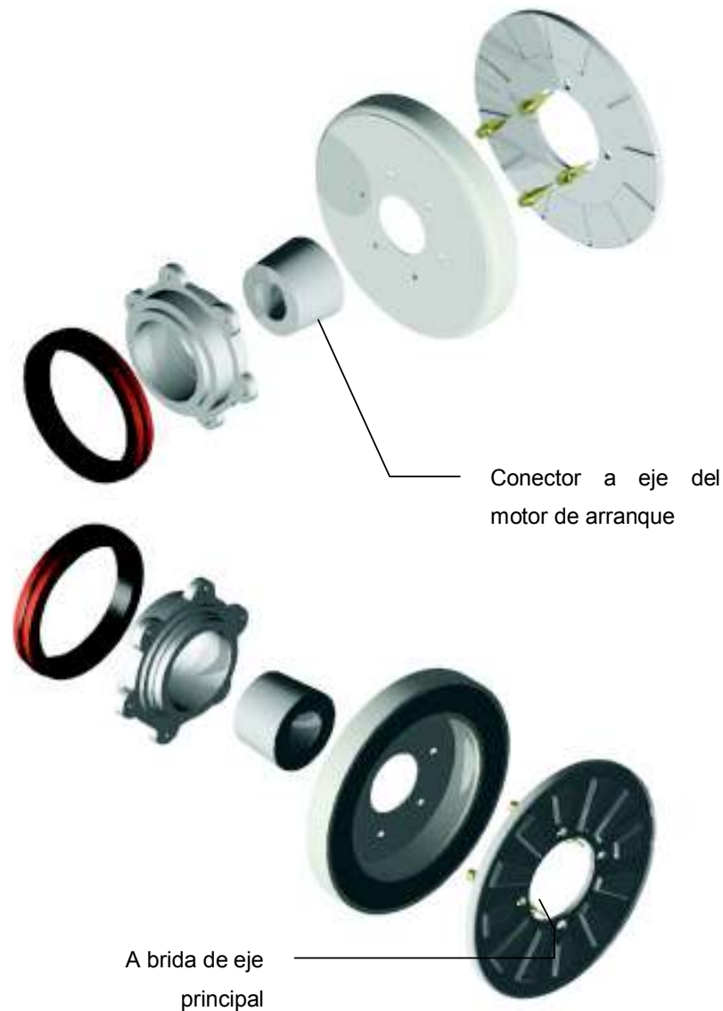
Figura 2.18: Embrague magnético
