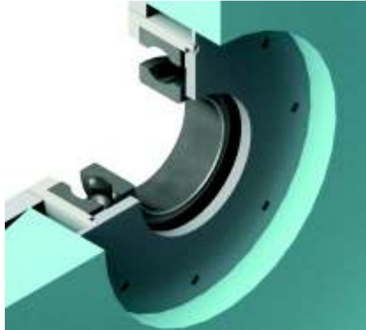
Figura 2.20: Vista frontal, corte del sistema de apoyo del rodamiento posterior.
