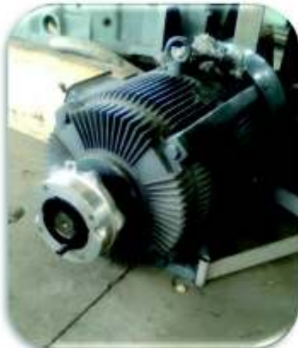
Motor eléctrico de arranque acoplado parcialmente al embrague mecánico (Figura 2.18 Conector)
