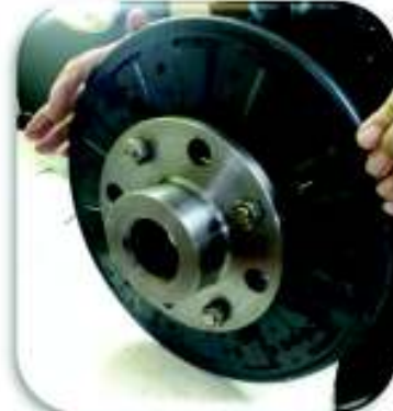
Pieza de la Figura 2.17 c) finalizada y unida al embrague magnético (Vista anterior)
