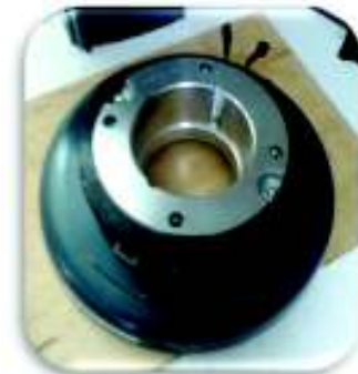
Embrague magnético (anillos rozantes) y acople hacia motor eléctrico
