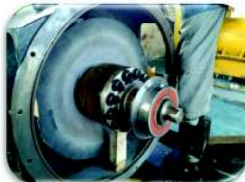
Acople de la pieza de la Figura 2.17 al eje del generador síncrono
