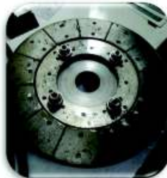
Pieza de la Figura 2.17 c) finalizada y unida al embrague magnético (Vista posterior)
