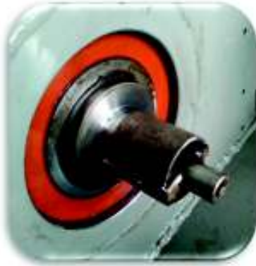
Pieza especial construida para medir el torque necesario para sacar el conjunto rotórico de la inercia
