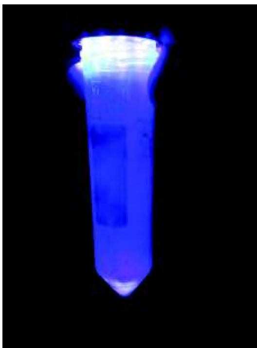
FIGURA 4.5 FOTOGRAFÍA DE PUNTOS CUÁNTICOS \text{CuInS}_2 BAJO LUZ UV
