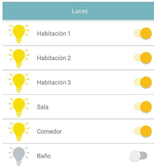
Figura 3.7. Encendido de luminarias desde la interfaz de usuario
