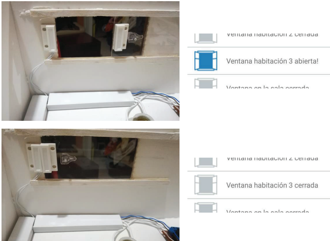
Figura 3.11. Pruebas del sensado de apertura/cierre de puerta y ventanas
