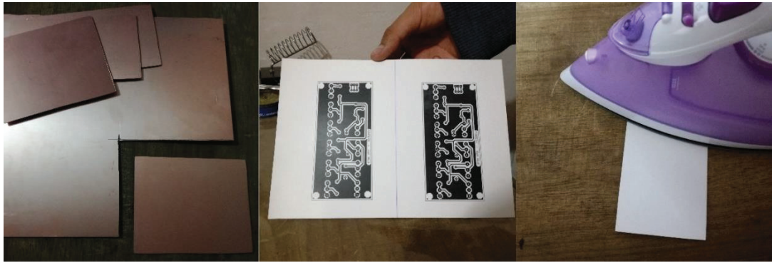
Figura 2.76. Proceso de transferencia de t ner a baquelita
