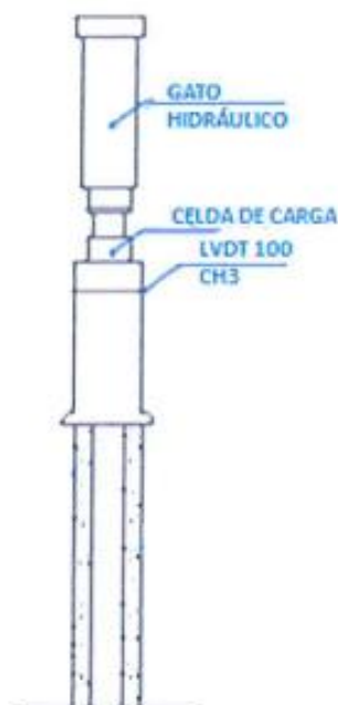
Figura 2.5: Prensa hidráulica, con celda de carga puede aplicar hasta 100 Ton.
