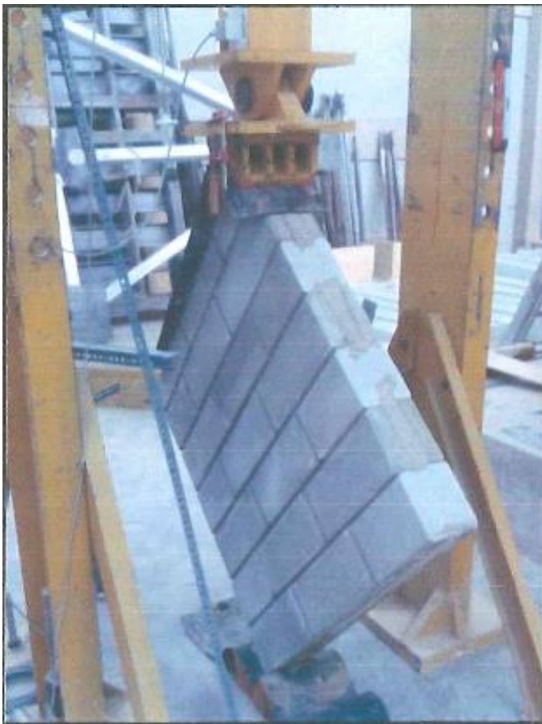
Fotografía 2.3: Ensayo de tensión diagonal en muro de 100 cm x 100 cm
