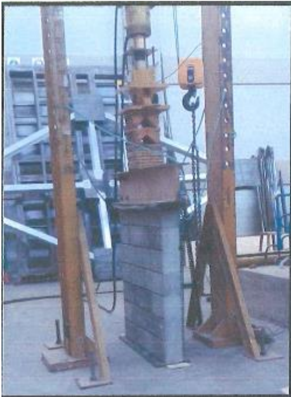
Fotografía 2.1: Ensayo de compresión axial en muro de 115 cm x 100 cm
