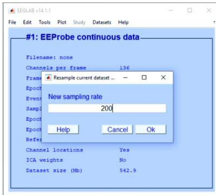
Figura 2.4. Remuestreo de la señal de EEG a 200 Hz
