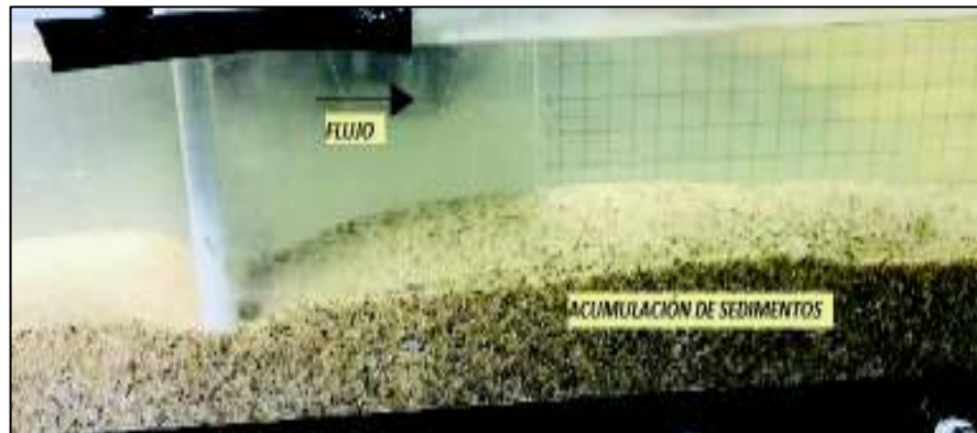
FIGURA 2. 6 Acumulación de sedimentos aguas abajo.
