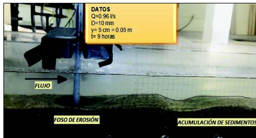
FIGURA 4. 29 Desarrollo de la erosión, vista lateral izquierda (9 horas): Pila 10 mm, Calado 5 cm.
