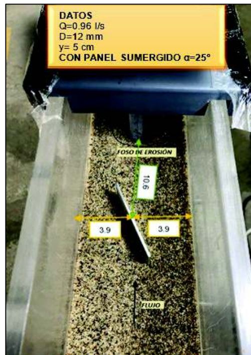
FIGURA 4. 52 Implantación del panel: Pila 12mm, Calado 5cm
