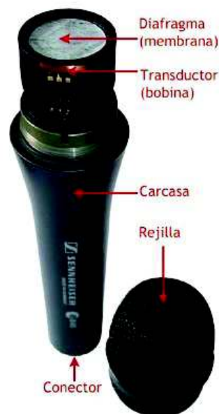
Figura 1.5 Partes principales de un micrófono [15].
