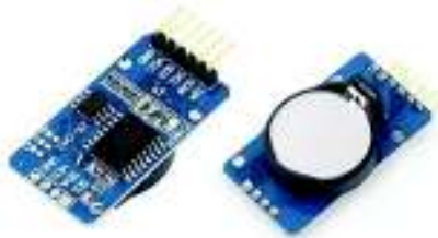
Figura 3.8 Esquema general del reloj en tiempo real (RTC) DS1307/ DS3231
