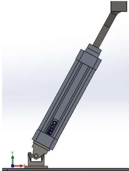
Figura 2.5. Junta prismática robot paralelo 3UPE+RPU.
