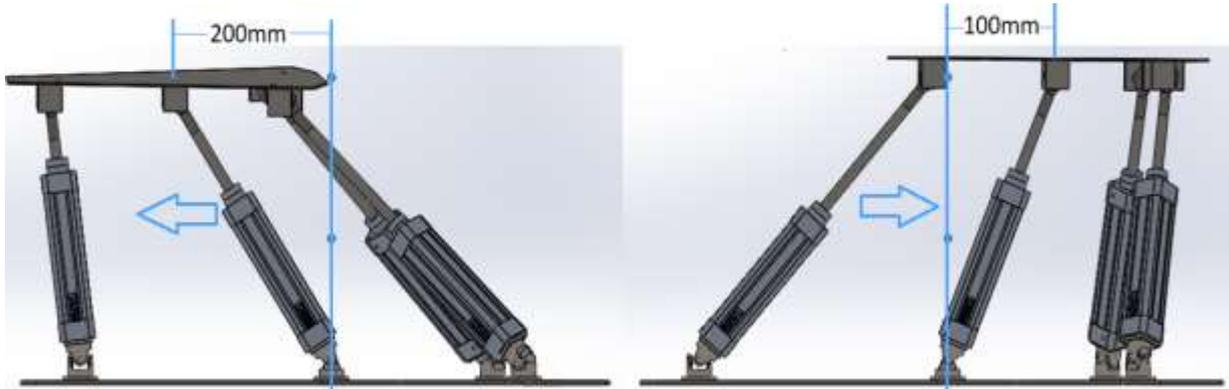
Figura 2.7. Desplazamiento del robot en el eje X.
