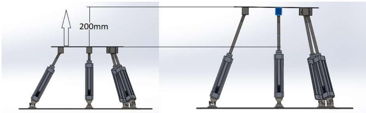
Figura 2.6. Posición inicial y final del movimiento en Z.
