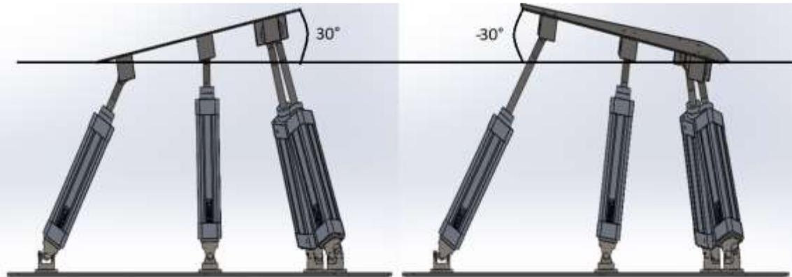
Figura 2.9. Movimiento de giro alrededor del eje Y.
