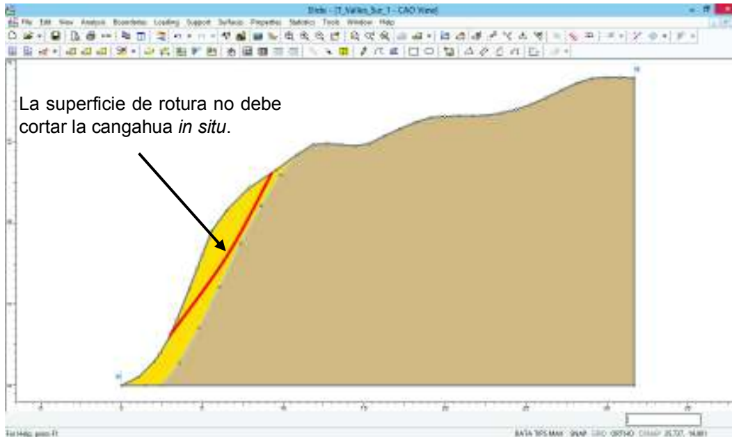
Figura 3. 7 Dibujo de la superficie de rotura, herramienta Add Surface programa Slide.
