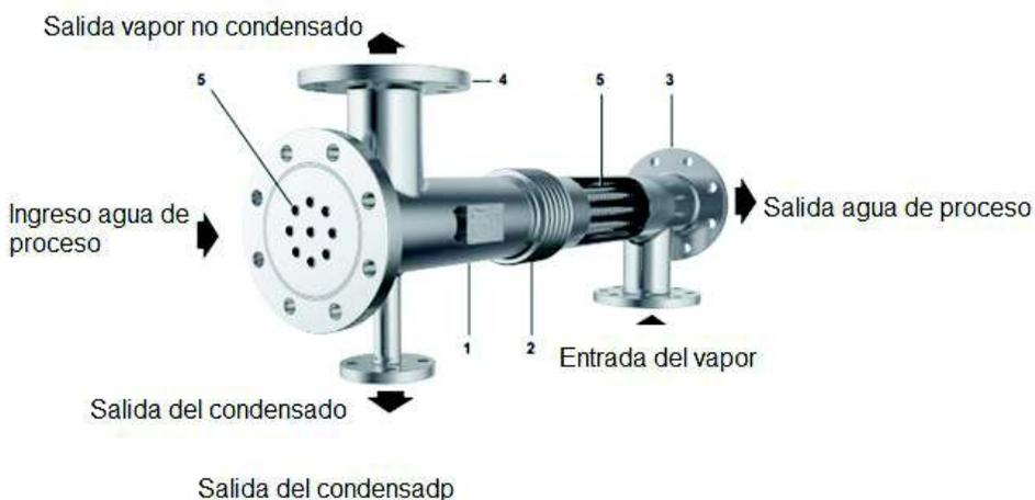
**Figura AIV. 3** Vista frontal condensador Parcial EVC-1F
