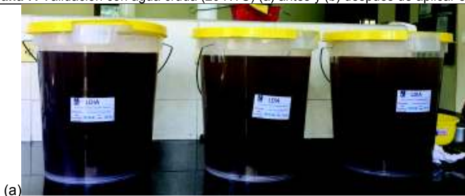
Fotografía 7. Validación con agua cruda (20 NTU) (a) antes y (b) después de aplicar el kit.
