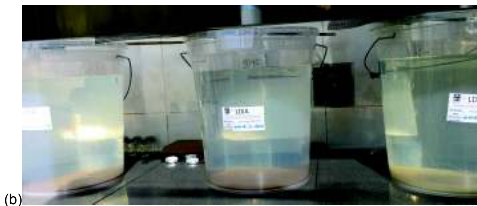
Fotografía 8. Validación con agua cruda (70 NTU) (a) antes y (b) después de aplicar el kit.
