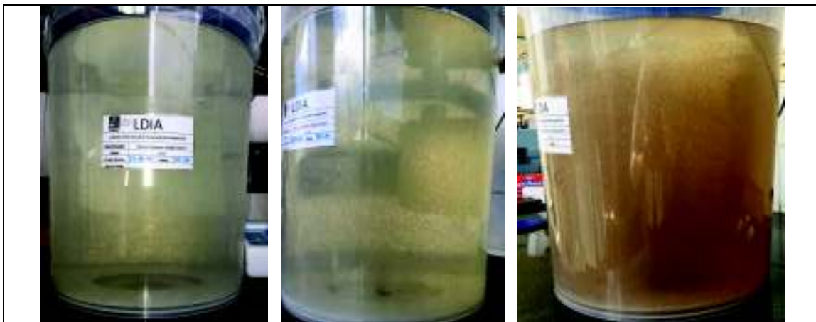
Fotografía 9. Formación de flocs en agua cruda de 10, 20 y 70 NTU, respectivamente
