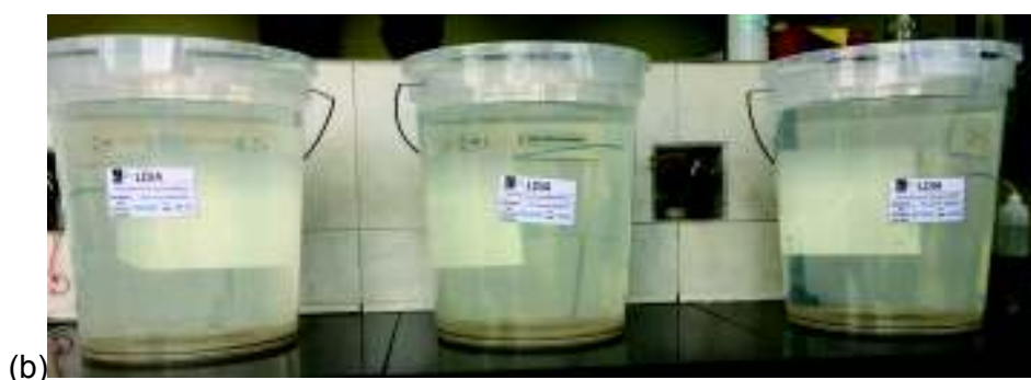
Fotografía 7. Validación con agua cruda (20 NTU) (a) antes y (b) después de aplicar el kit.
