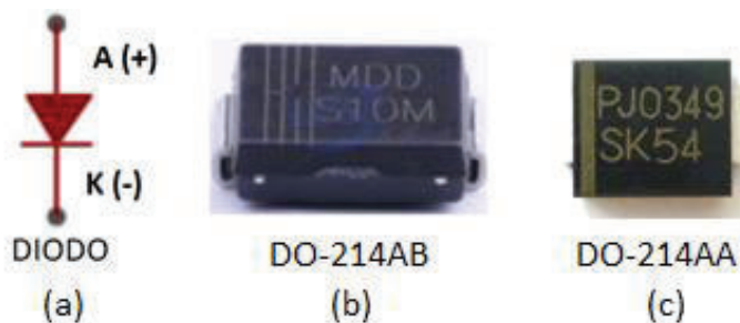
Figura 2.19. Símbolo y diodos smd: (a) símbolo de diodo. (b) diodo S10M. (c) diodo SK54
