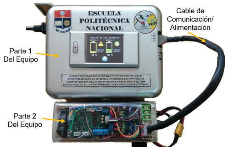
Figura 3.6. Conexión para comunicación entre las dos partes del equipo
