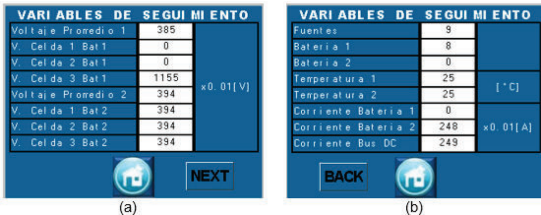
Figura 3.9. Variables del sistema: (a) voltajes en las baterías. (b) otras variables
