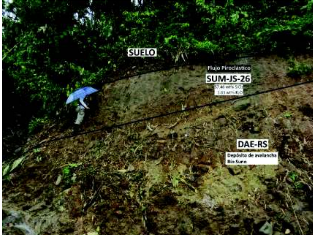
Figura 3.38 Depósito de flujo piroclástico (SUM-JS-26), ubicado en la mina del Consejo Provincial de Orellana, margen izquierdo del Río Suno. El depósito es de composición traquiandesítico. (239248/9931636, 497 msnm/ UTM WGS84-18S).
