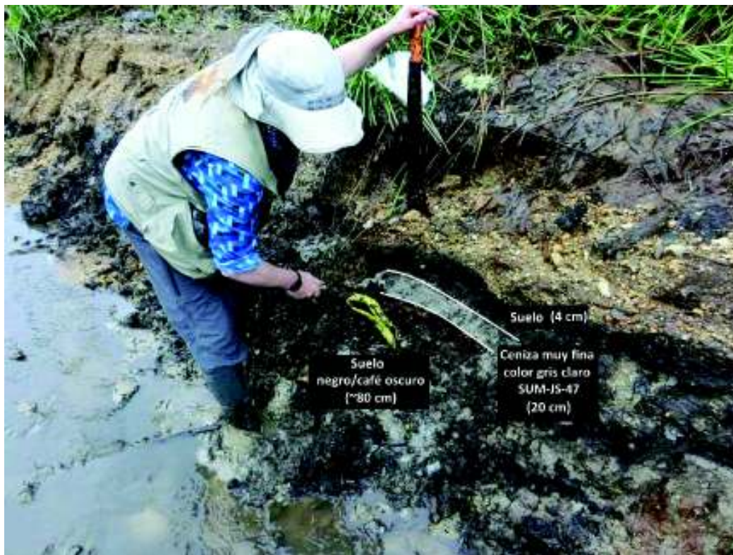
Figura 3.26 Sección estratigráfica Ciénega, se ha identificado un depósito de ceniza muy fina (SUM-JS-47), color gris claro intercalada con niveles de suelo muy oscuro. (18M 186979/9951021, 1689 msnm / WGS84-18S).
