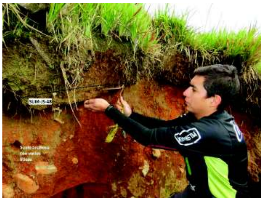
Figura 3.23 Recolección de la muestra “SUM-JS-48”, en la sección “Cedros”. La muestra de ceniza es fina, con varios líticos de pómez. Es muy similar a la muestra “SUM-JS-50”, de la sección Linares.
