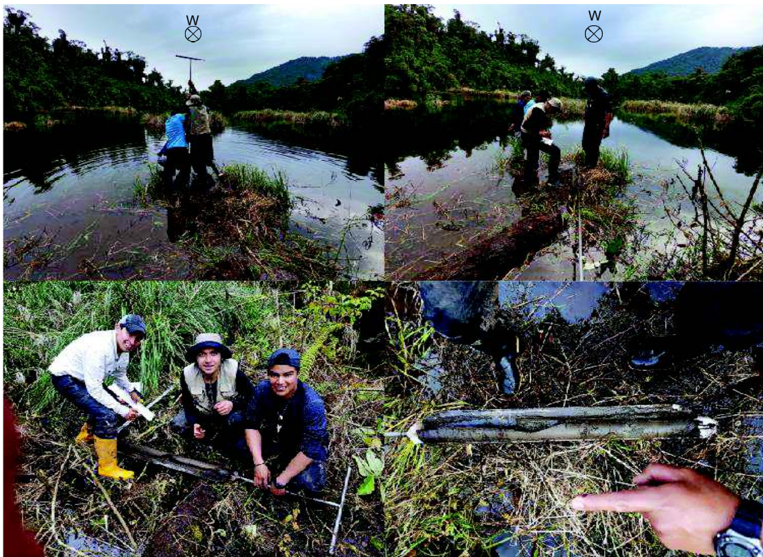
Figura 3.62 Resumen fotográfico de la obtención del testigo de perforación SUM-001, en las orillas de la Laguna Guagua Sumaco. La perforación alcanzó una profundidad de 3 metros y se identificó 9 capas de ceniza intercaladas con niveles de turba y sedimento. La fotografía derecha abajo corresponde al primer metro perforado.
