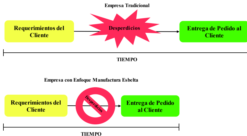
Figura 1.3 Tiempo de entrega empresa tradicional vs empresa esbelta (Villaseñor y Galindo, 2007, p. 25)
