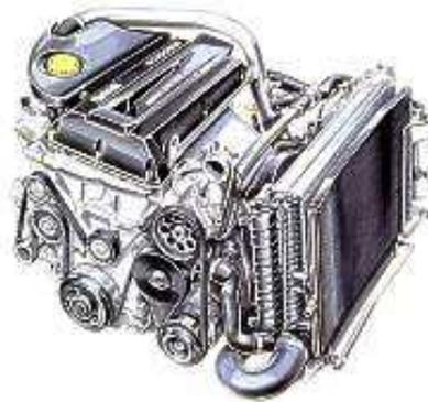
Figura 1.17 Circuito de refrigeración
