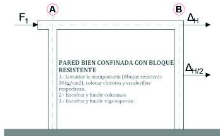
FIGURA 3.11 ESQUEMA PÓRTICO 2 ENSAYOS IDEAL ALAMBREC
