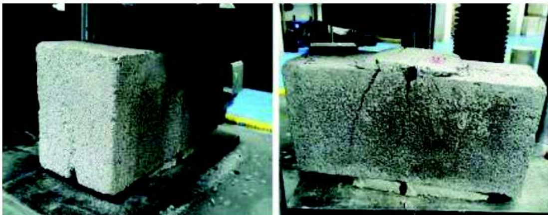
FIGURA 1.2 ENSAYO A COMPRESIÓN DE BLOQUE DE CONCRETO
