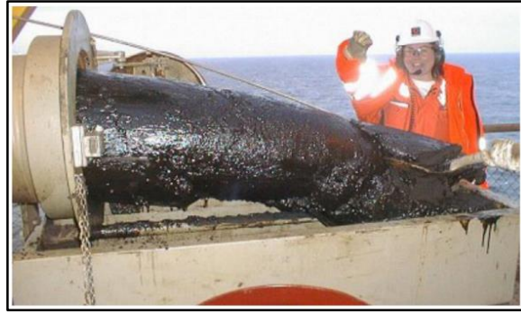
Figura 1.8: Tapón de cera plataforma Statfjord B, Noruega. Fuente: (Irmann-Jacobsen, 2015)
