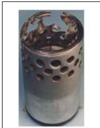
Figura 1.15: Daño por erosión en un estrangulador tipo jaula Fuente: (Stanko, 2017)
