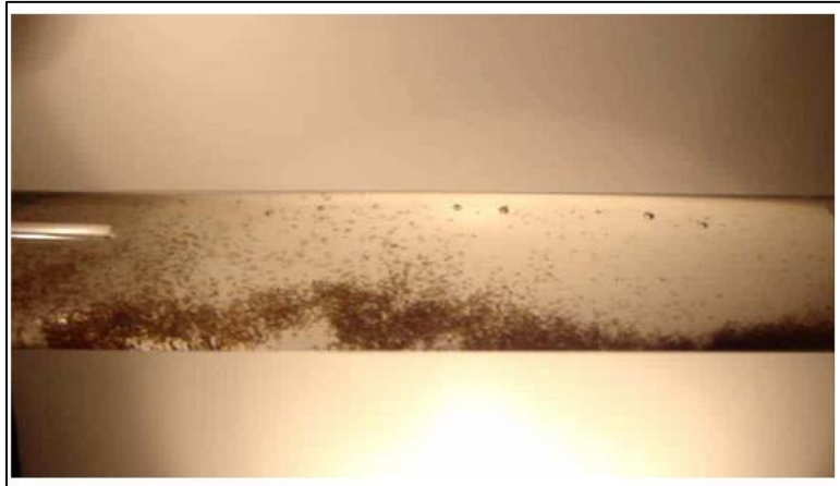
Figura 1.14: Régimen de heterogéneo-saltación transporte de arena en líneas de flujo Fuente: (Nikhar, 2006)
