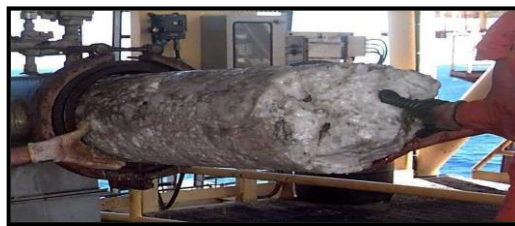
Figura 1.6: Tapón de hidrato Fuente: (Stanko, 2017)
