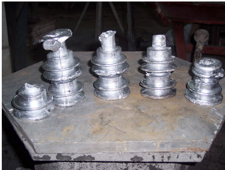
Fig. 31.1 Piezas realizadas en el molde metálico
