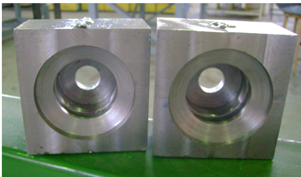
Fig. 20 Torneado de la huella en los bloques
