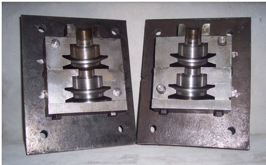
Fig. 23 Molde metálico completo
