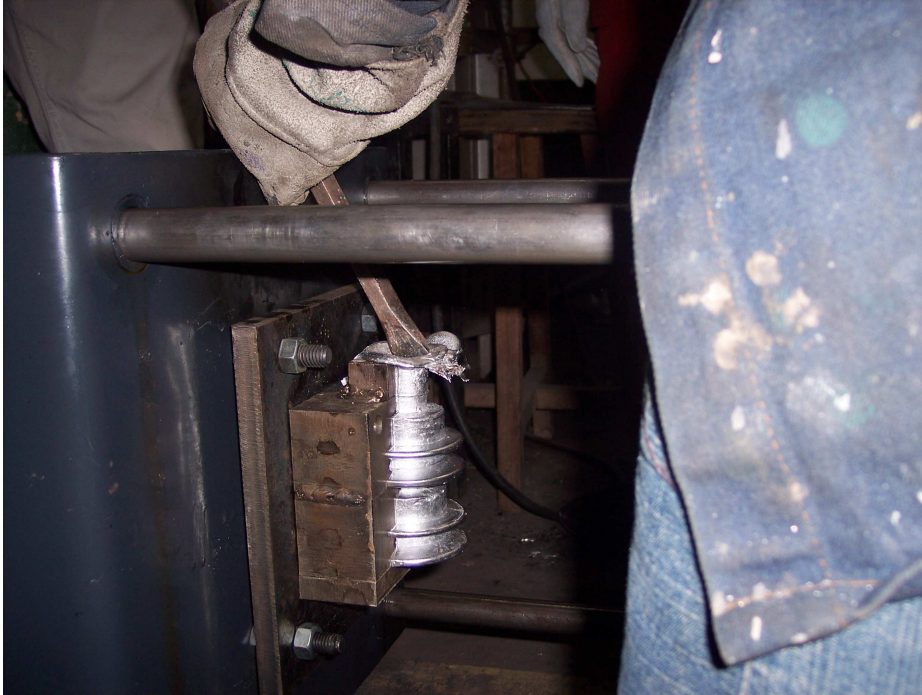
Fig. 31 Desmoldeo de la pieza
