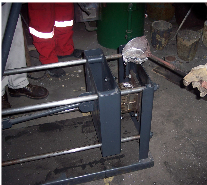
Fig. 30 Colado del aluminio en el molde metálico
