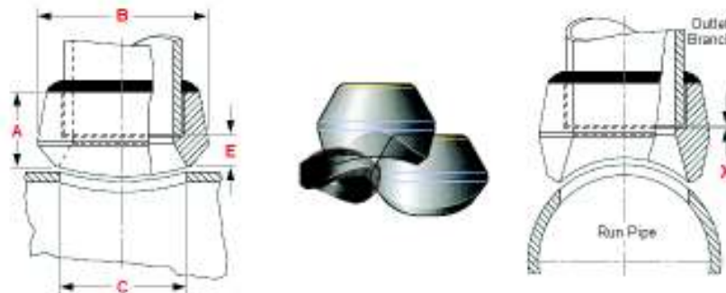
Figura 1.4. Dimensiones del elemento soldable (Sockolet). (Fuente: http://metcare.com.tr/sockolet ).
