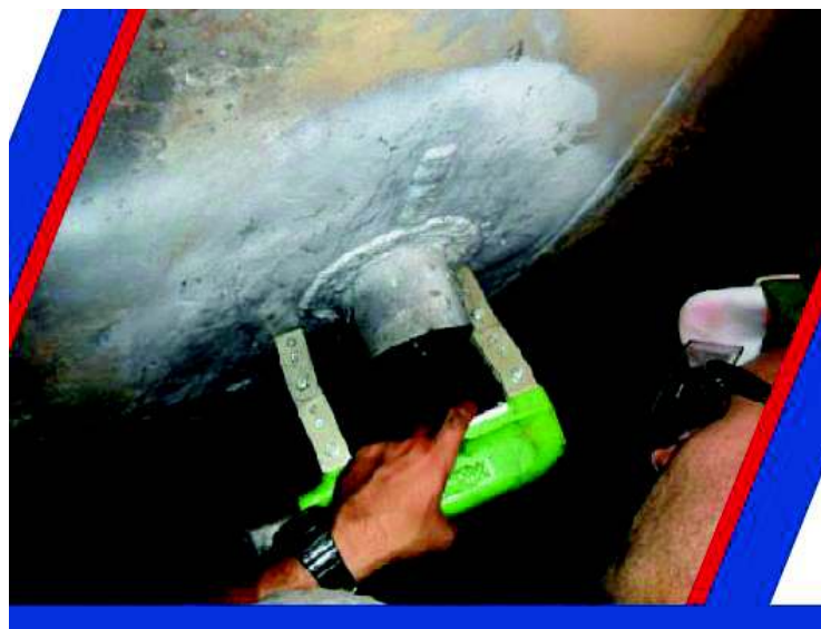
Figura 1.10. Ensayo con partículas magnéticas. (Fuente: http://www.rent-industrial.com/producto/inspeccion-mediante-particulas-magneticas-mt/ ).
