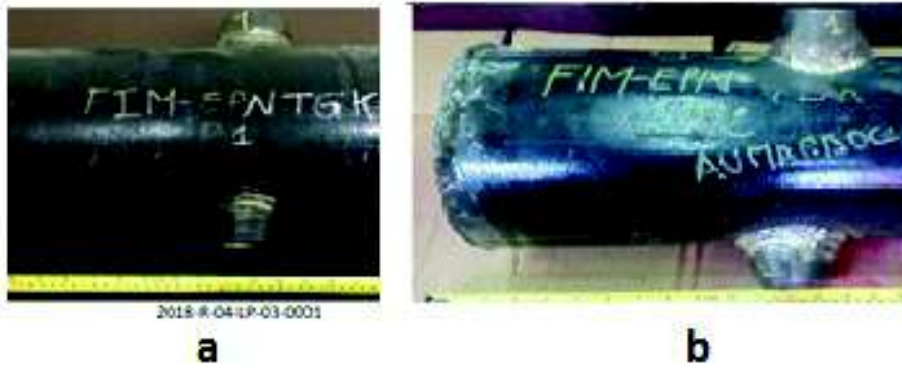
Figura 2.6. Probeta para el ensayo Radiográfico a) Caso 1 b) Caso 2. (Fuente: AUMAPROC S.A.).
