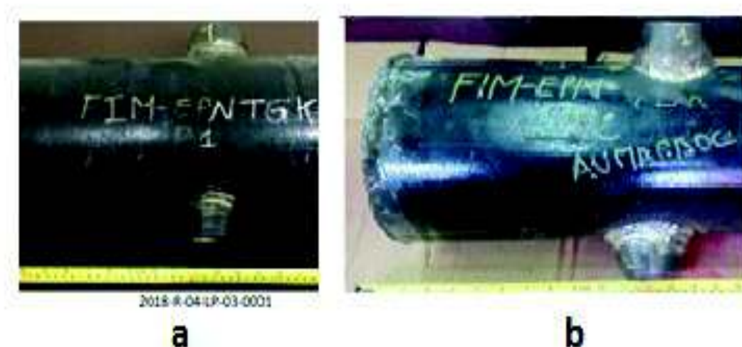
Figura 2.5. Probetas para el ensayo de partículas magnéticas a) Caso 1 b) Caso 2. (Fuente: Laboratorio de END-EPN).
