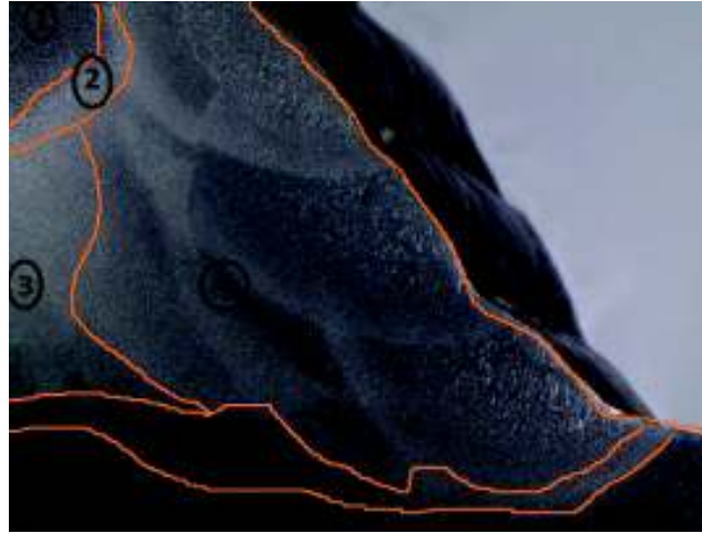
Figura 3.11. Zonas de análisis metalográfico caso 2 (Probeta con procedimiento convencional). (Fuente: Propia).
