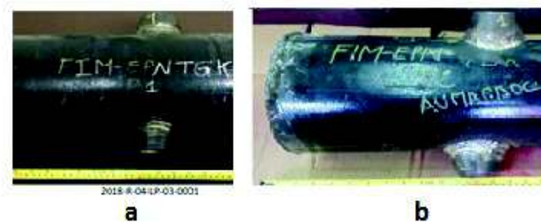
Figura 2.4. Probetas para el ensayo de líquidos penetrantes a) caso 1 b) caso 2. (Fuente: Laboratorio END-FIM-EPN).
