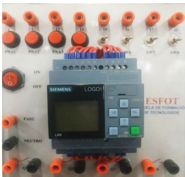
Figura 26. Relé programable modelo 230 RCE. Elaboración: Propia.
