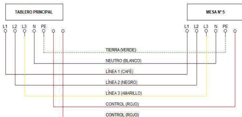
Figura 7. Esquema de los conductores eléctricos Elaboración: Propia.
