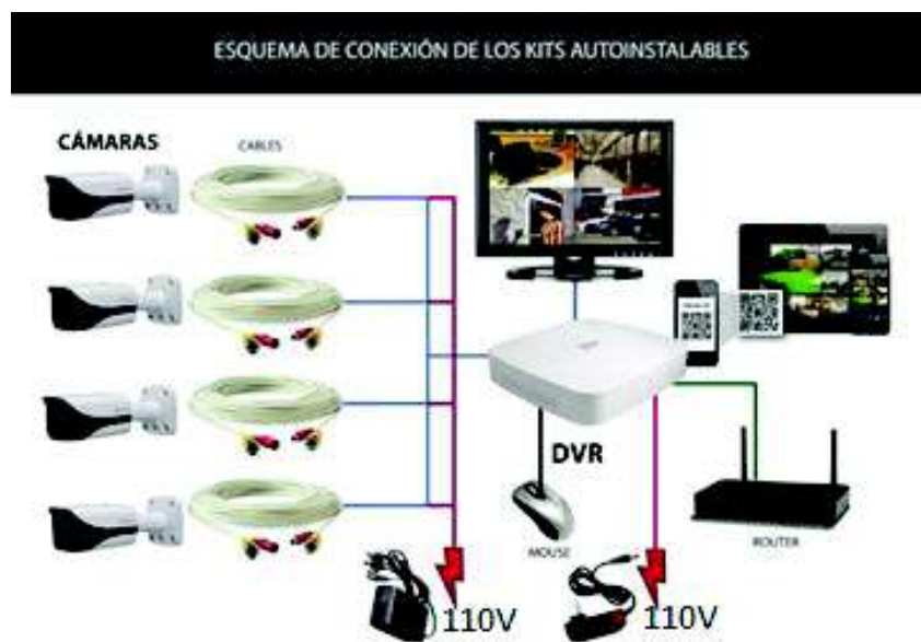
Figura 7: Esquema de sistema CCTV Fuente: [11]
