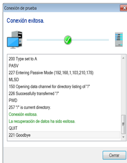
Figura 2.40. Especificación de transferencia y prueba de conexión [25]
