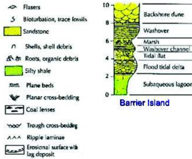
Figura 2.15. Columna sintética de facies verticales de barrera (retrogradacional). Modificado de Bevis (2014).
