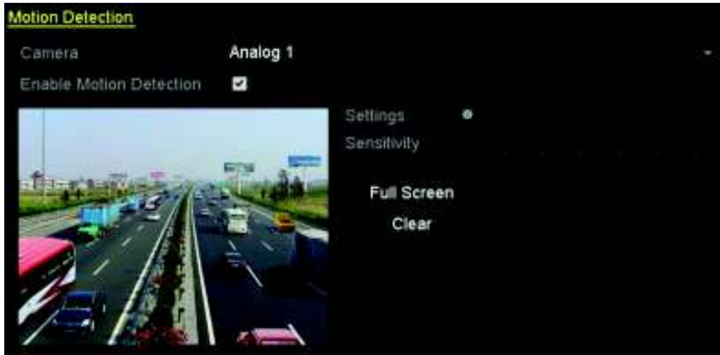
Figura J.30: Configuración para detección por movimiento
