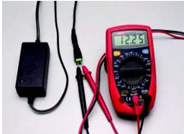
Figura I.2: Comprobación fuente de poder
