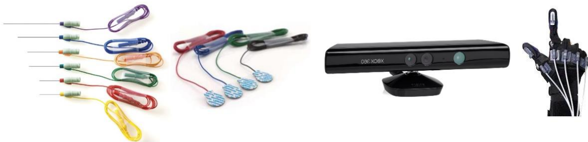
Figura 3 Herramientas para la obtención de señales EMG, de izquierda a derecha: electrodos de aguja EMG, electrodos adhesivos superficiales, cámara de profundidad (Kinect), guante instrumentado.
