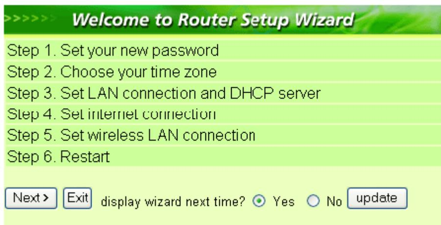
**Figura 5.9 Asistente de configuración rápida**
