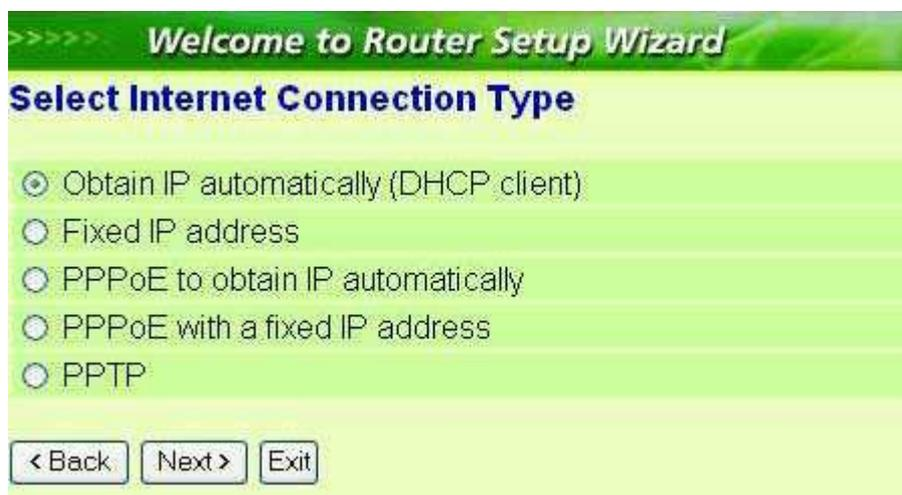
**Figura 5.13 Paso 4. Tipo de conexión**
