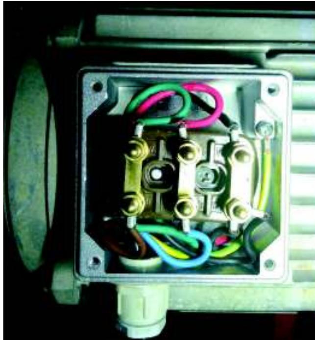
Figura 37.- Conexión eléctrica del motor maestro.
