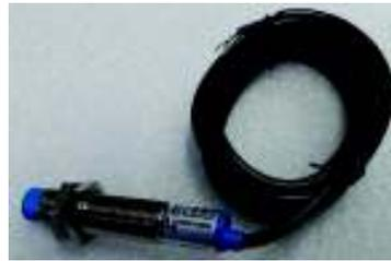
Figura 4.-Sensor inductivo de 3 hilos PNP.
