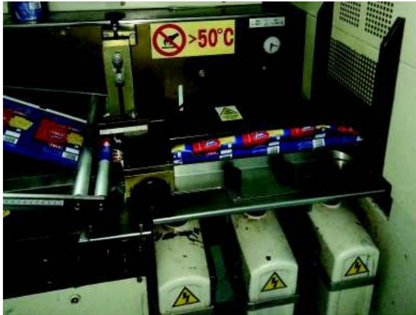
Figura 16.- Introducción de papel de empaque dentro de las ruedas de precalentamiento y termosoldadoras.
