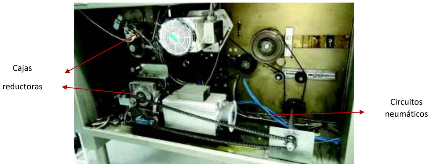
Figura 19.- Motores y mecanismos de la máquina.
