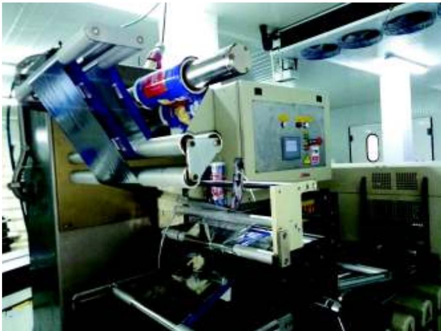
Figura 15.- Calibración del rollo de papel de empaque.
