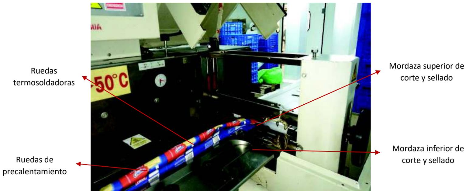
Figura 13.-Elementos de corte y sellado de la máquina.
