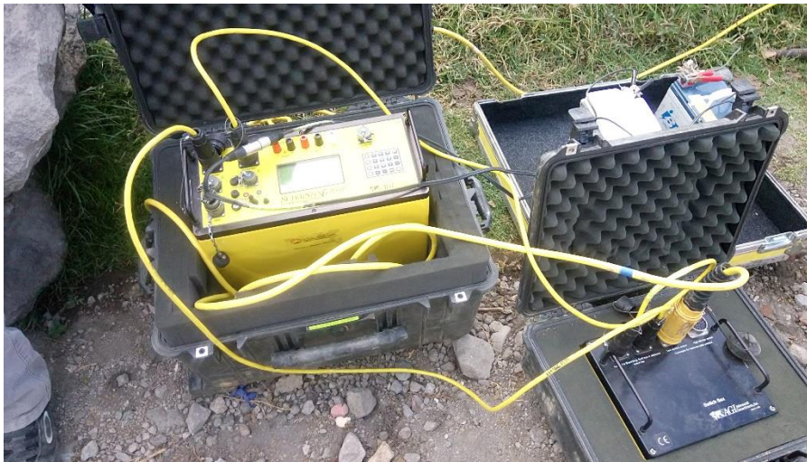
Fig. 3.4. Equipos para la realización de las Tomografías Eléctricas
