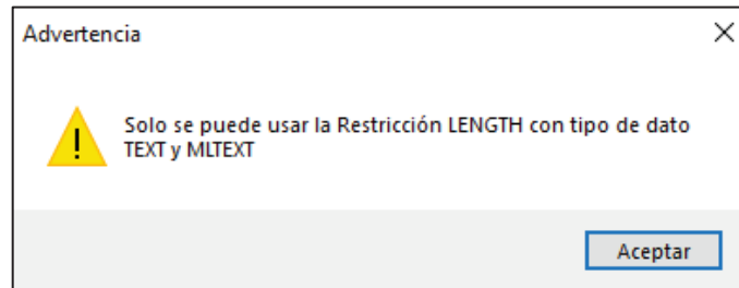
Figura 3.70 Error. La restricción de longitud solo se aplica a los tipos string
