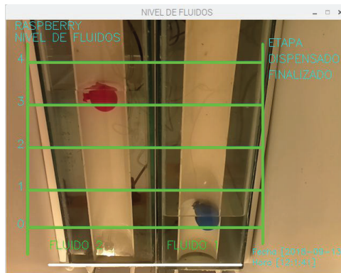
Figura 3. 57. Interfaz de fluidos nivel inferior. Prueba 1.
