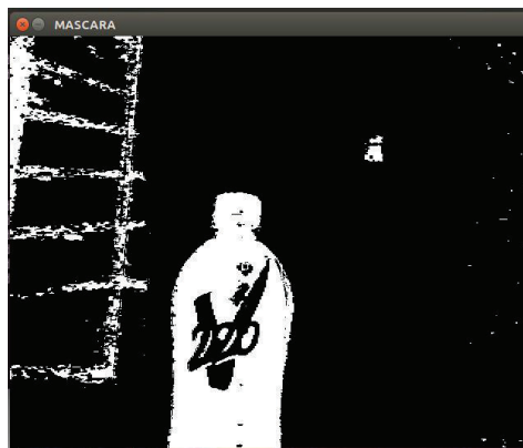
Figura 3. 17. Máscara del detector de colores azules.
