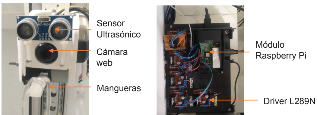
Figura 3. 3. Carrete transportador y tablero de control.
