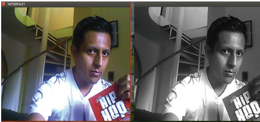
Figura 3. 4. Trasformación de BGR a Escala de grises.
