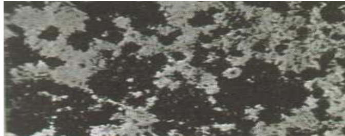
Fig. 1.10. Micro estructura de la troostita
