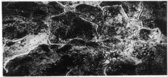
Fig. 1.6. Micro estructura de la cementita
