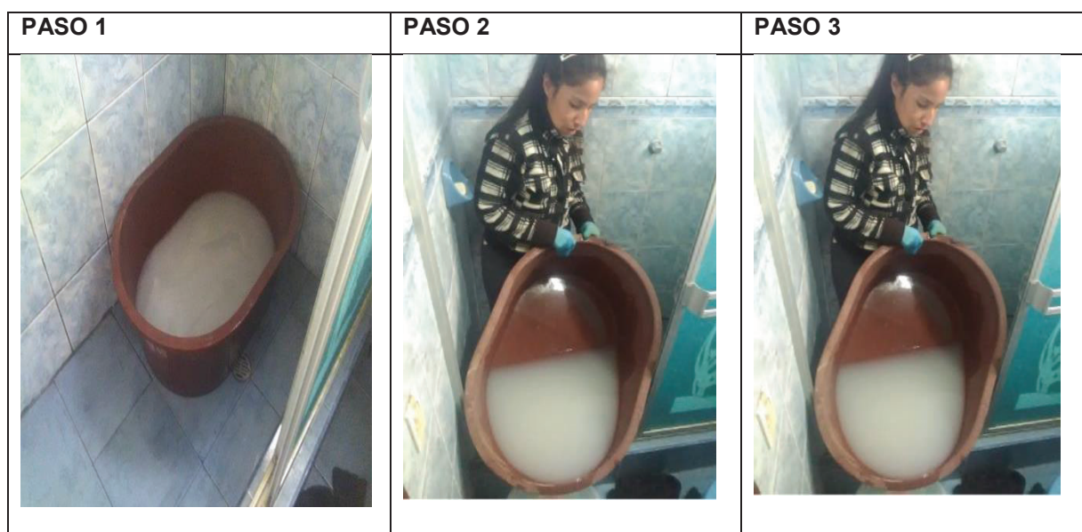
Figura 4: Procedimiento de recolección de agua gris en duchas
