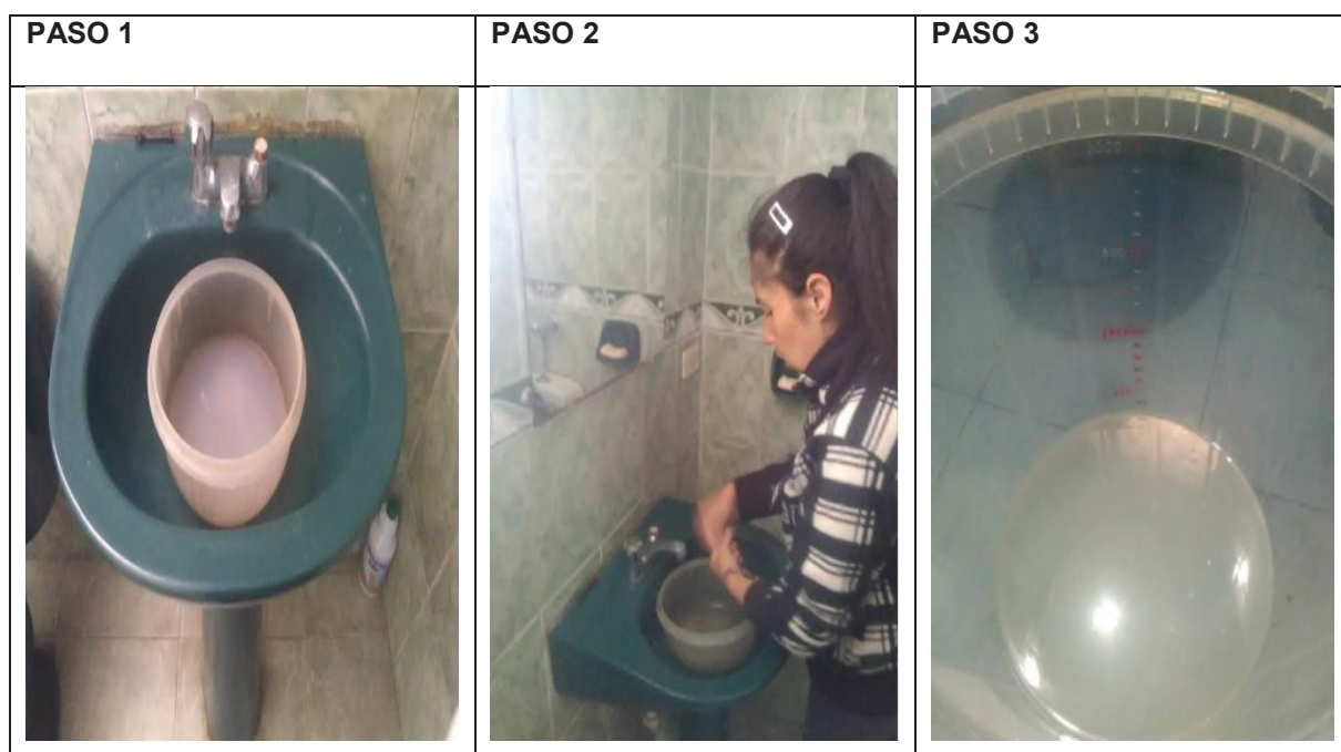
Figura 5 Procedimiento de recolección de agua gris en lavamanos.
