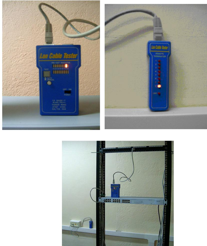
**FIGURA 2.8: EQUIPO AT&T UTILIZADO PARA PRUEBAS DE CONTINUIDAD PUNTO A PUNTO**
