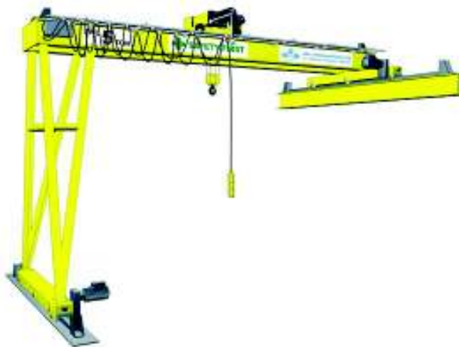
Figura 1.2. Grúa Semipórtico. (Fuente: (Fernandez, 2013))
