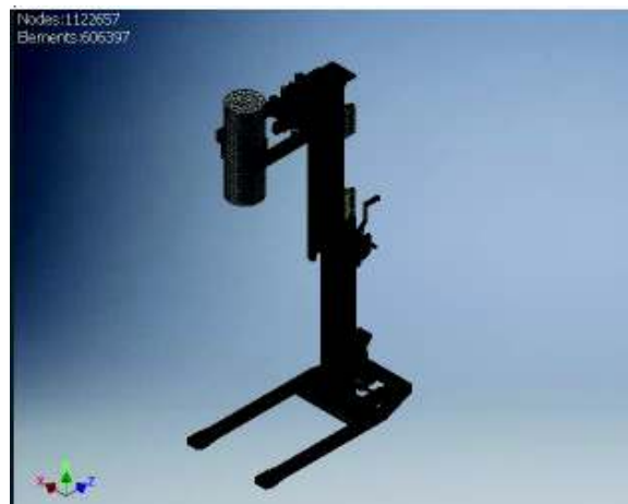
Figura 2.96. Mallado de mecanismo con reactor. (Fuente: Propia)
