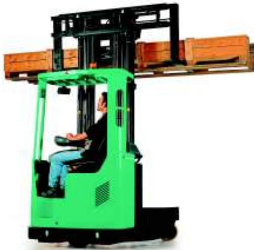
Figura 1.8. Carretilla elevadora de carga lateral. (Fuente: (Jungheinrich, 2018))
