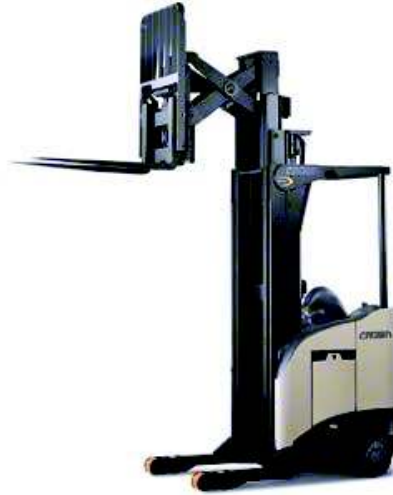
Figura 1.7. Carretilla retráctil. (Fuente: (Jungheinrich, 2018))
