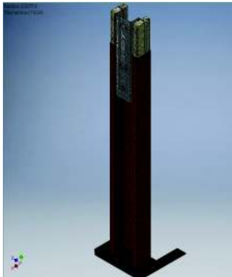
Figura 2.87. Generación del mallado de la columna principal. (Fuente: Propia)
