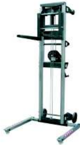
Figura 1.9. Carretilla elevadora manual. (Fuente: (KHmedia, 2018))
