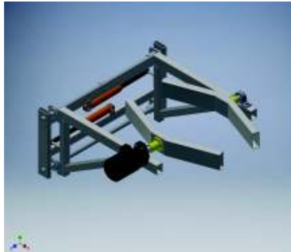
Figura 2.11. Mecanismo hidráulico de sujeción. (Fuente: Propia)
