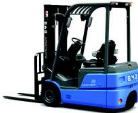
Figura 1.6. Carretilla elevadora contrapesada de 3 ruedas. (Fuente: (Jungheinrich, 2018))
