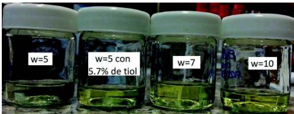
Figura 4.1: Nanopartículas de CdS sintetizadas en heptano, de izquierda a derecha: \omega = 5 , \omega = 5 con 5,7% en peso de dodecanotiol, \omega = 7 y \omega = 10 . Puede observarse que el tono de amarillo de la microemulsión es más concentrado para valores de \omega mayores. Además, la muestra con dodecanotiol no presenta una variación de color respecto de la que no posee dicho compuesto.
