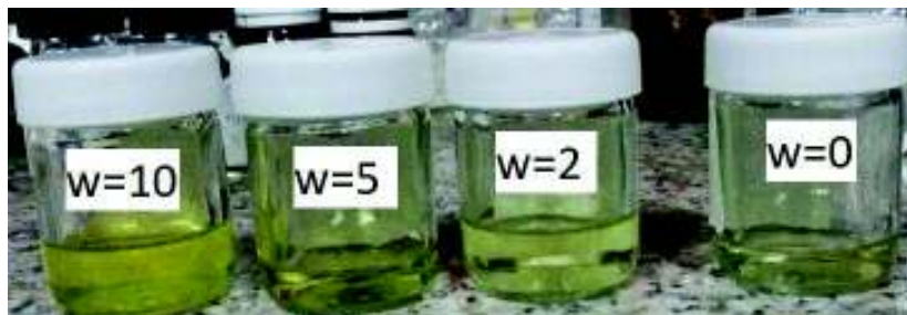
Figura 4.6: NPs sintetizadas con agua, AOT y hexano. De izquierda a derecha: w = 10 , w = 5 , w = 2 y w = 0 .
