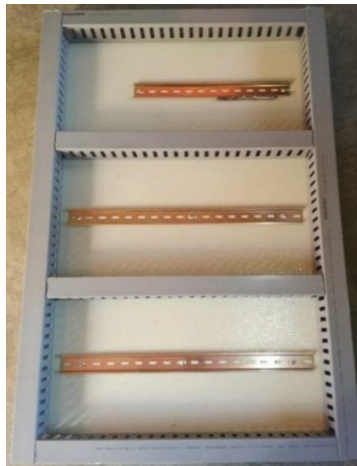
Figura 13. Placa interior del gabinete con canaletas y rieldin
