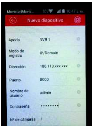
Figura 3. 29 Ingreso de datos del NVR.
