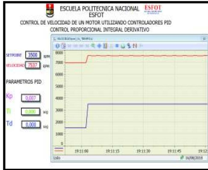
Figura 3.47 Control proporcional (P) con  $K_p = 0.007$  a 3500 rpm
