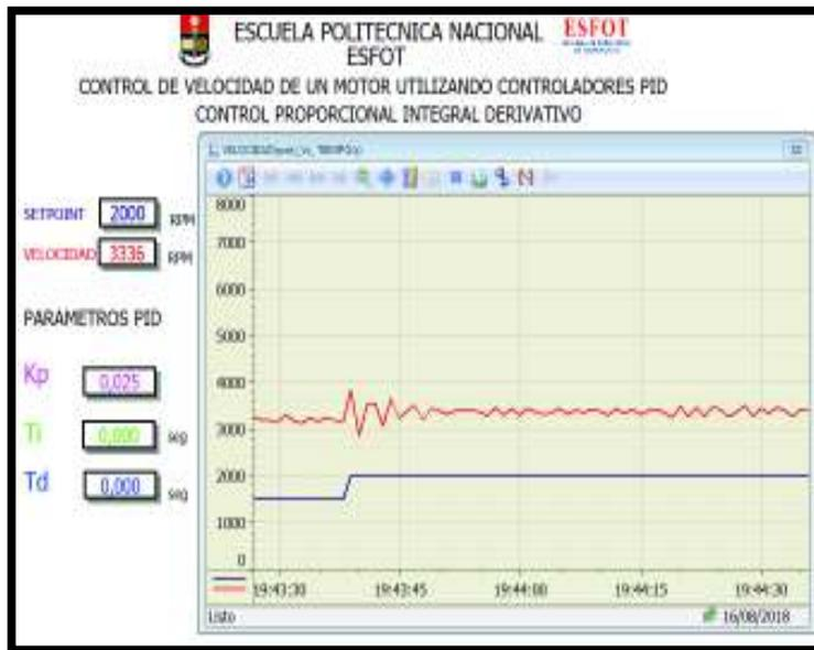
**Figura 3.45** Control proporcional (P) con  $K_p = 0.025$  a 2000 rpm
