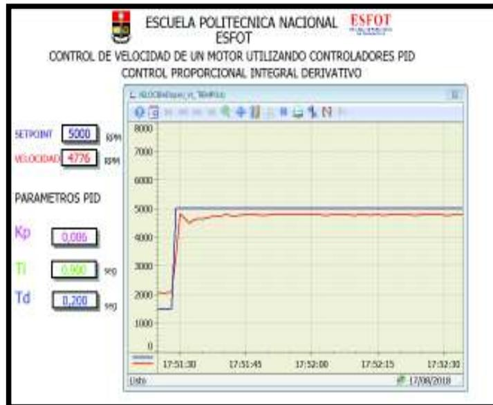
**Figura 3.64** Control (PID) con  $K_p= 0.006$ ,  $T_i= 0.90$ seg y  $T_d= 0.20$ seg a 5000 rpm
