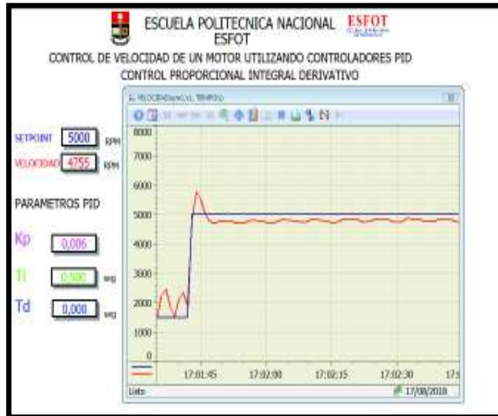
Figura 3.57 Control (PI) con  $K_p= 0.006$ ,  $T_i= 0.50$ seg a 5000 rpm
