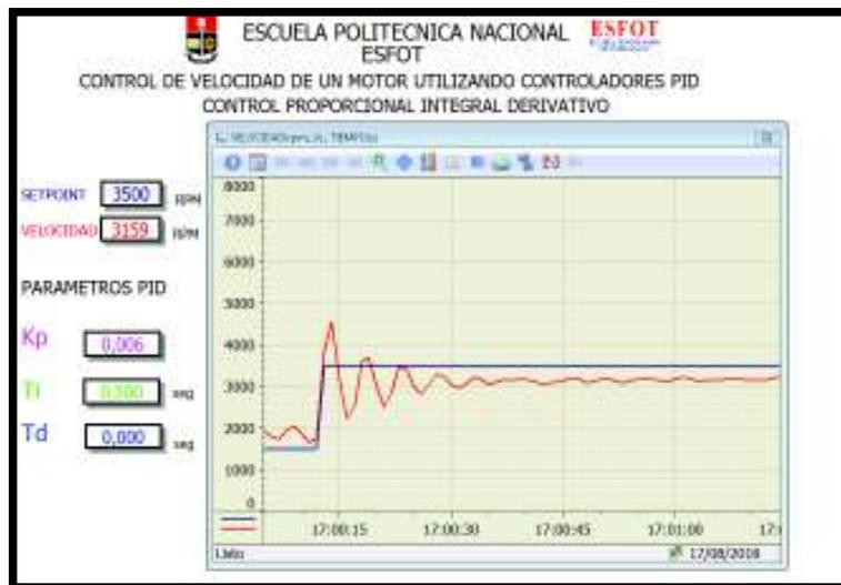
Figura 3.55 Control (PI) con  $K_p = 0.006$ ,  $T_i = 0.50$ seg a 3500 rpm
