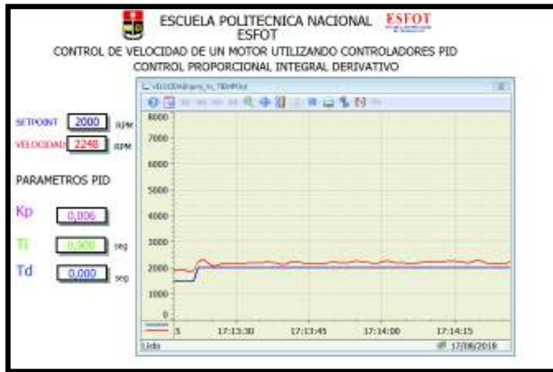
Figura 3.54 Control (PI) con  $K_p = 0.006$ ,  $T_i = 0.90$ seg a 2000 rpm
