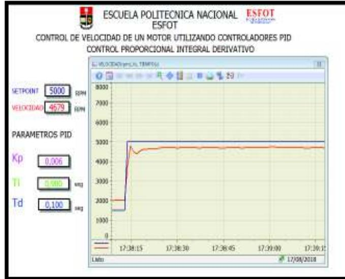
**Figura 3.63** Control (PID) con  $K_p= 0.006$ ,  $T_i= 0.90$ seg y  $T_d= 0.10$ seg a 5000 rpm. Al dar un valor a  $K_p = 0.006$ ,  $T_i = 0.90$  seg y  $T_d = 0.20$  seg se observa la acción de control que se muestra en la figura 3.64.
