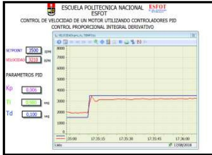
**Figura 3.61** Control (PID) con  $K_p= 0.006$ ,  $T_i= 0.90$ seg y  $T_d= 0.10$ seg a 3500 rpm
