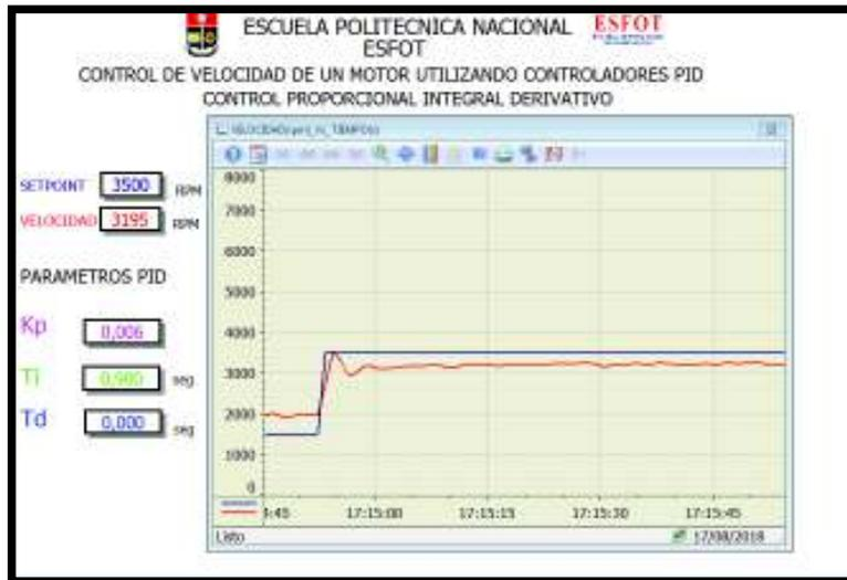
Figura 3.56 Control (PI) con  $K_p= 0.006$ ,  $T_i= 0.90$ seg a 2000 rpm
