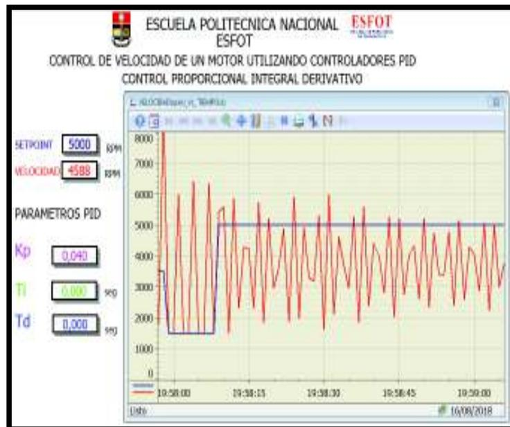
**Figura 3.52** Control proporcional (P) con  $K_p = 0.040$  a 5000 rpm
