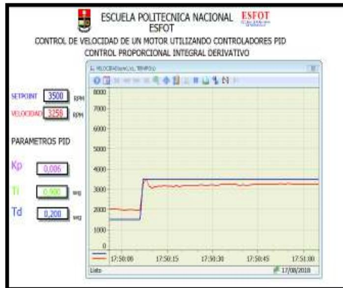
**Figura 3.62** Control (PID) con  $K_p= 0.006$ ,  $T_i= 0.90$ seg y  $T_d= 0.20$ seg a 3500 rpm
