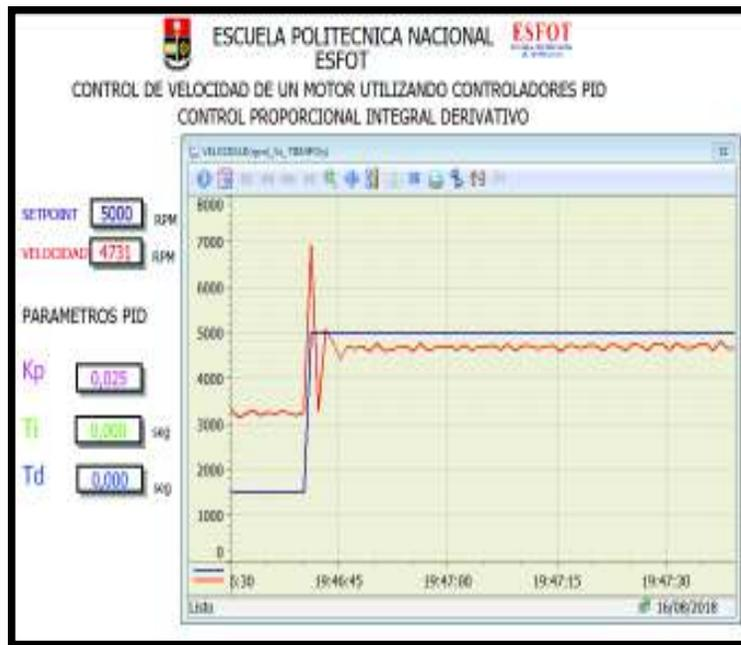
**Figura 3.51** Control proporcional (P) con  $K_p = 0.025$  a 5000 rpm
