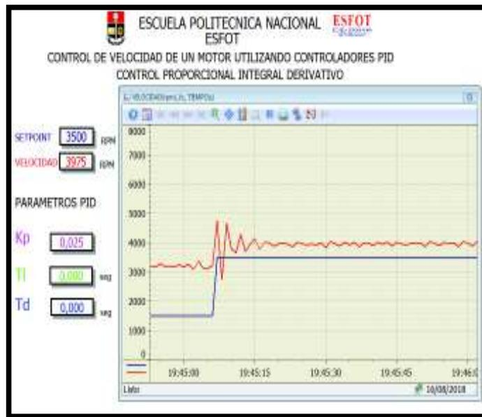
Figura 3.48 Control proporcional (P) con  $K_p = 0.025$  a 3500 rpm
