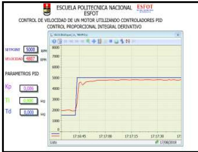
**Figura 3.58** Control (PI) con  $K_p = 0.006$ ,  $T_i = 0.90$ seg a 5000 rpm
