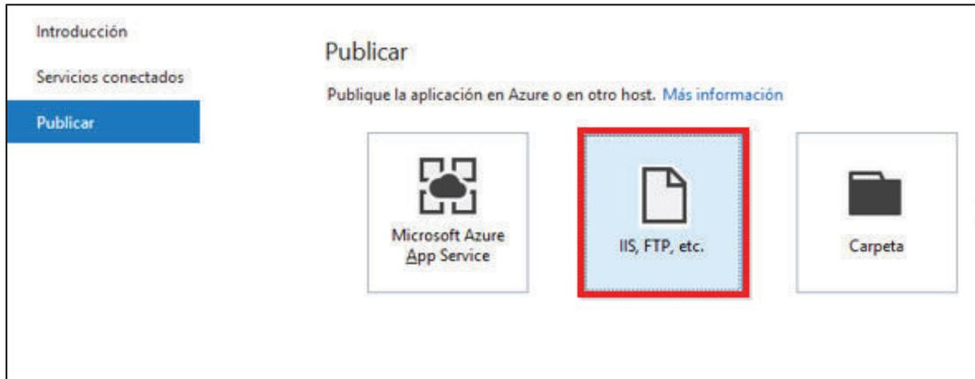
**Figura 2.46** Publicar los servicios Web mediante servidor IIS.
