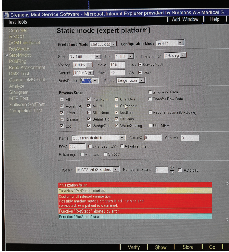
Figura 3.2: Configuración en modo de servicio, modulo static mode que permite utilizar el tubo de rayos X en una posición fija.
