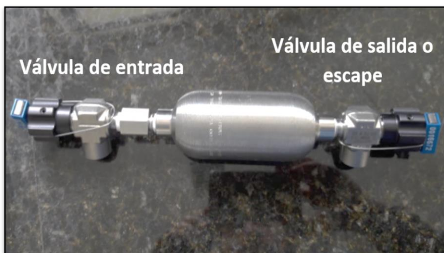
Figura 2.2. Contenedor de acero inoxidable para el almacenamiento de GLP
