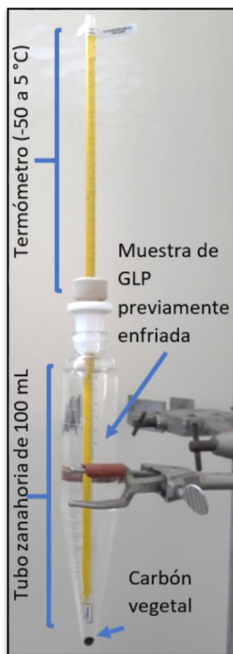
Figura 2.5. Equipo para determinar la temperatura al 95 % de evaporación del GLP.
