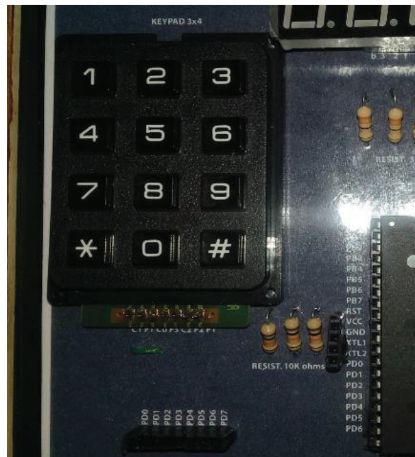
Figura 3.22 Teclado matricial 3x4 conectado al puerto D
