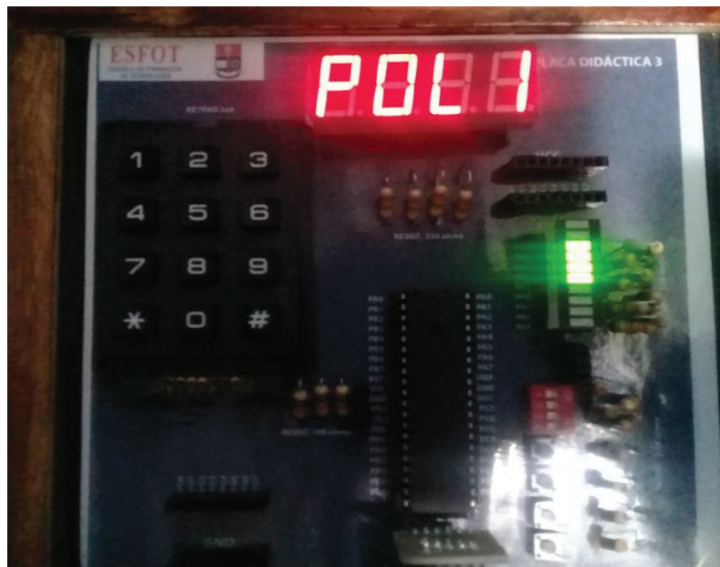
Figura 3.52 Prueba de funcionamiento práctica 5 opción 2 “POLI”
