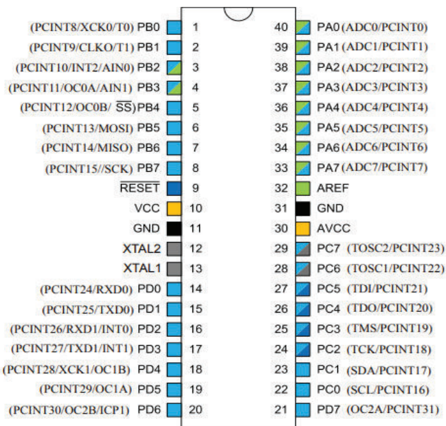
Figura 1.1 Distribución pines ATmega164PA [1]
