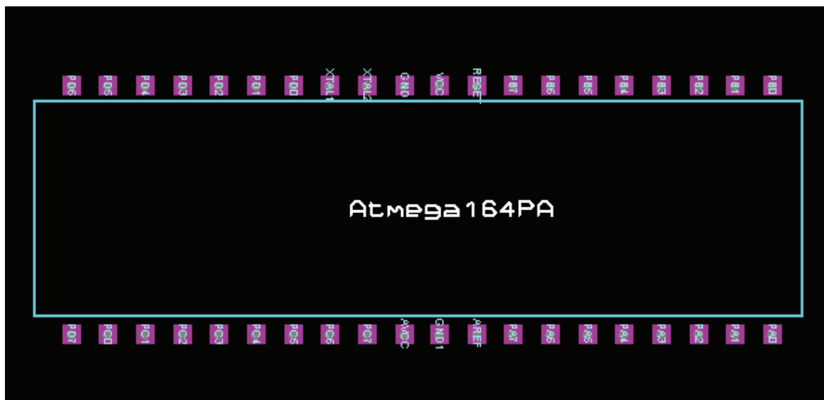
Figura 3.5 Representación física del microcontrolador ATmega164PA [1]
