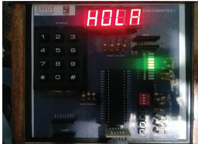
Figura 3.51 Prueba de funcionamiento práctica 5 opción 2 “HOLA”
