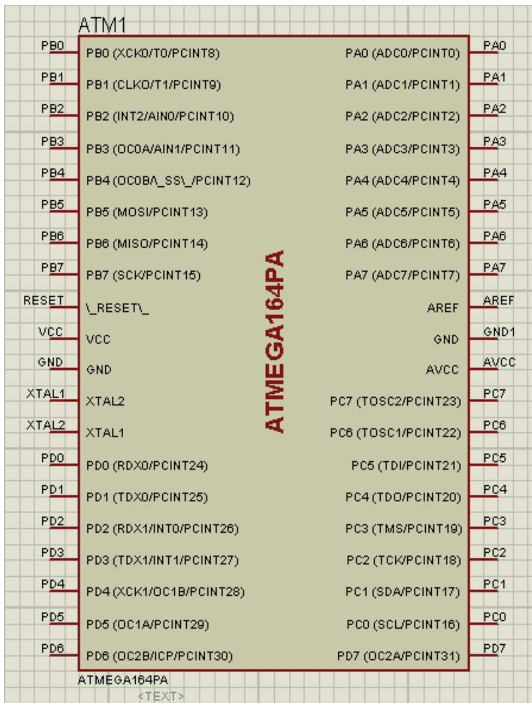
Figura 3.3 ATmega164PA símbolo lógico [1]
