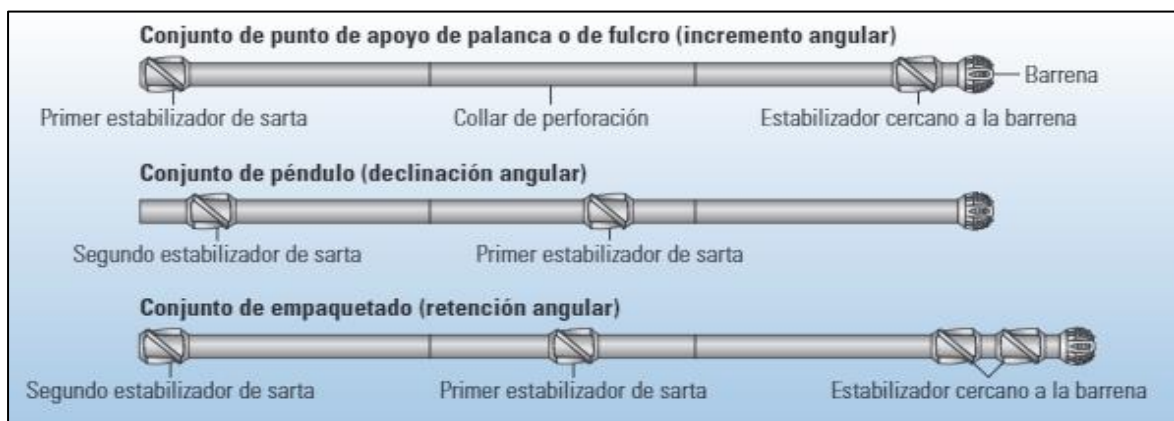
Figura 1.9. BHA de construcción, pendular y para mantener ángulo.
