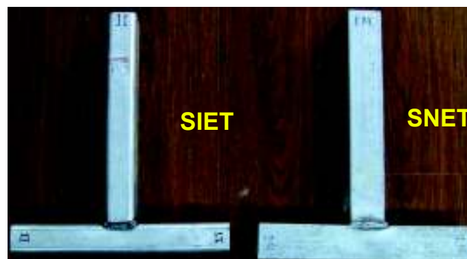
Figura 2.12. Tubo estructural galvanizado, soldadura en T para análisis visual. (Fuente: Propia, 2018)
