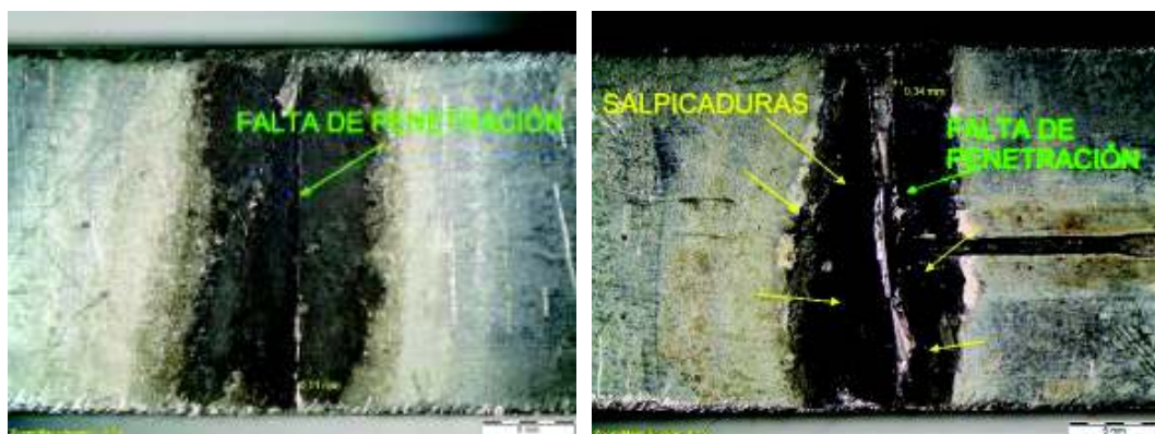
Figura 3.14. Discontinuidades TSN, superficie interna. (Fuente: Propia, 2018)
