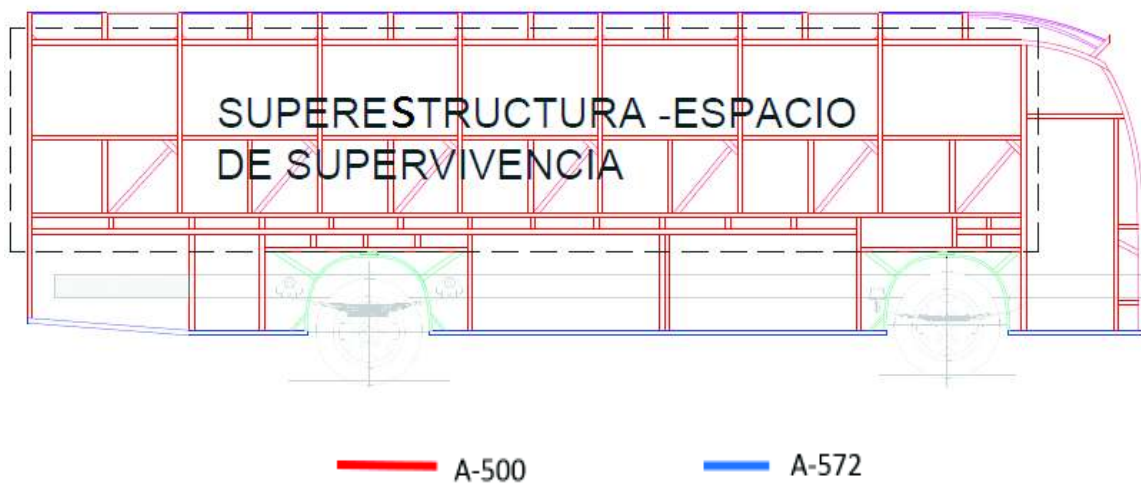
Figura 2.2. Estructura lateral derecha de un autobús de fabricación nacional. (Fuente: Planos de Simulación. Anexo C)
