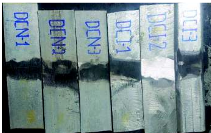
Figura 2.15. Probetas para ensayo de doblado de cara. (Fuente: Propia, 2018)
