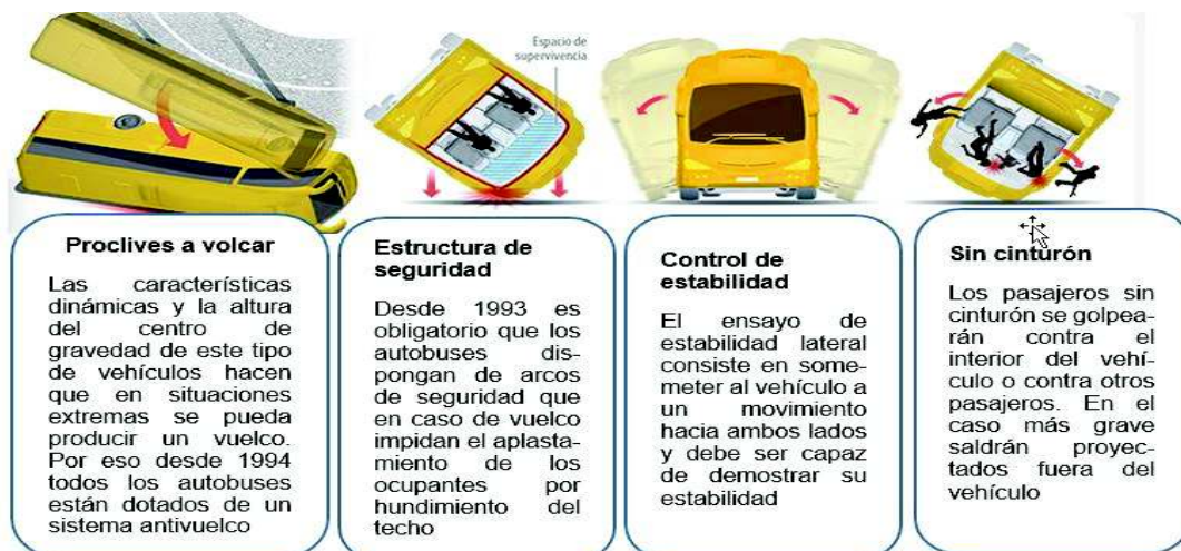
Figura 1.11. Parámetros de volcamiento. (Fuente: Propia, 2018)
