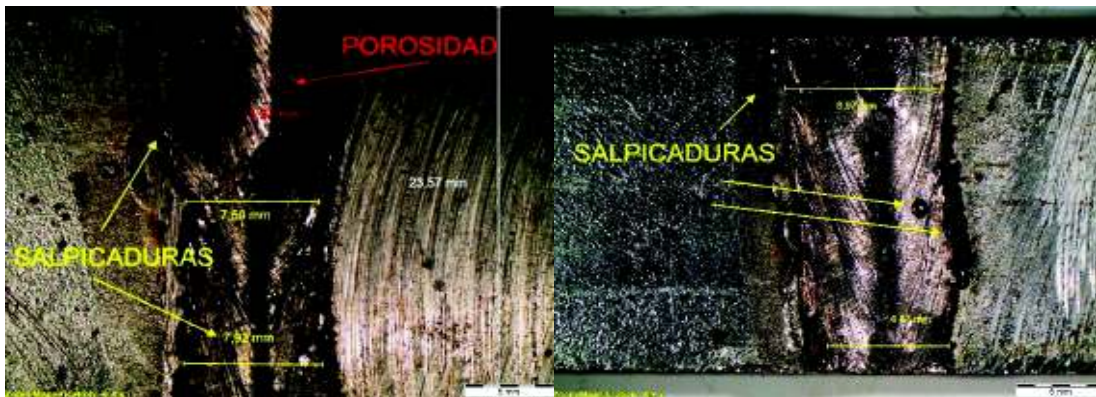
Figura 3.42. Discontinuidades TSI, superficie externa. (Fuente: Propia, 2018)
