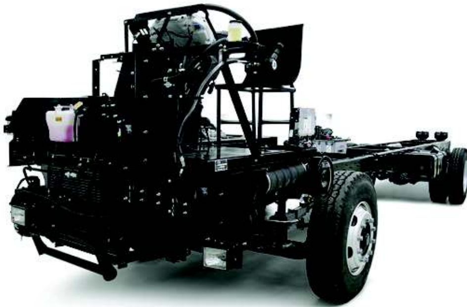
Figura 1.2. Estructura básica del chasis tipo escalera. (Fuente: Manual montaje de carrocería modelo HINO AK8JRSA:2015)
