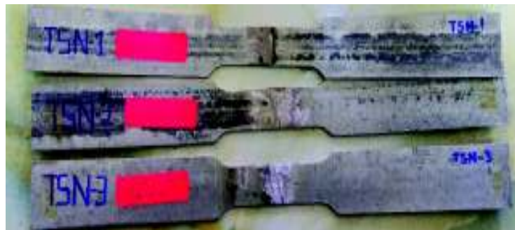
Figura 2.19. Probetas para ensayo de tensión soldadas producto nacional. (Fuente: Propia, 2018)
