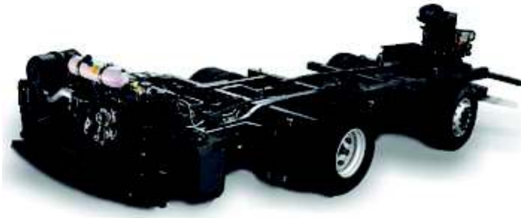
Figura 1.3. Estructura básica del chasis tipo buggy. (Fuente: Manual montaje de carrocería modelo Scania K360:2015)
