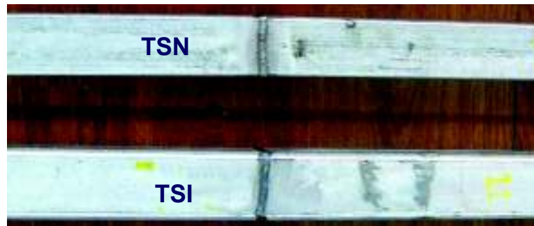
Figura 2.11. Tubo estructural galvanizado, soldadura a tope para análisis visual. (Fuente: Propia, 2018)
