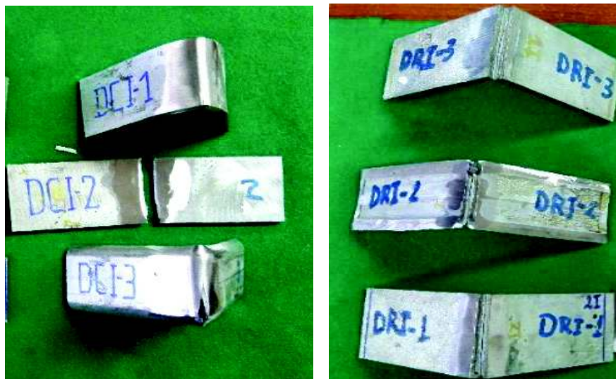
Figura 3.46. Probetas TSI sometidas a ensayos de doblado de cara y raíz. (Fuente: Propia, 2018)
