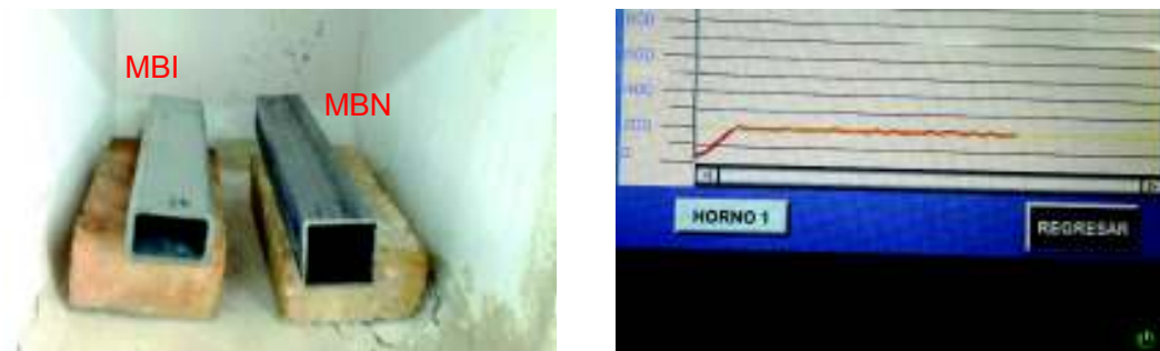
Figura 3.8. Ensayo por enfriamiento brusco MBN y MBI, zona de supervivencia. (Fuente: Propia, 2018)
