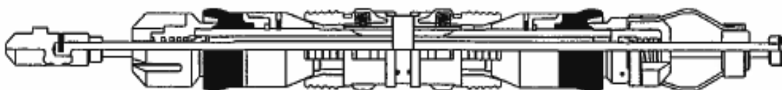
Figura 3.21 RBP bridge plug Fuente: (Baker Hughes, 2003)
