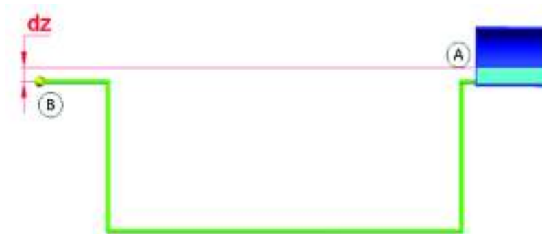
Figura 2.15. Definición del parámetro dz , y de los puntos de entrada y salida de la línea.
