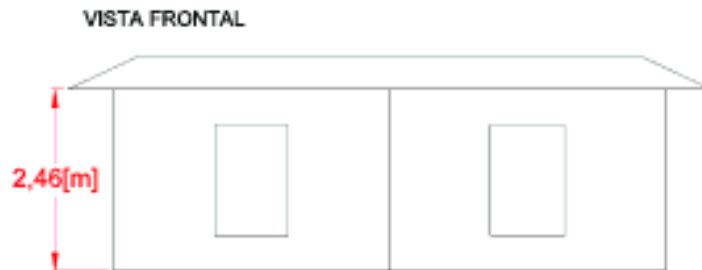
Figura 2.7. Vista frontal de la vivienda.
