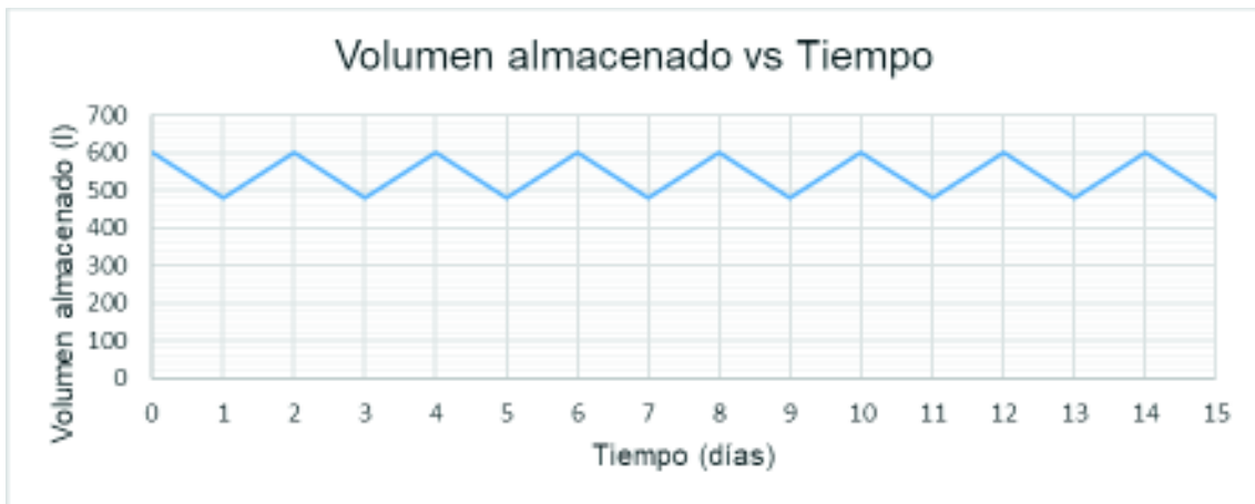
Figura 2.9. Volumen almacenado vs Tiempo condiciones promedio 600l.
