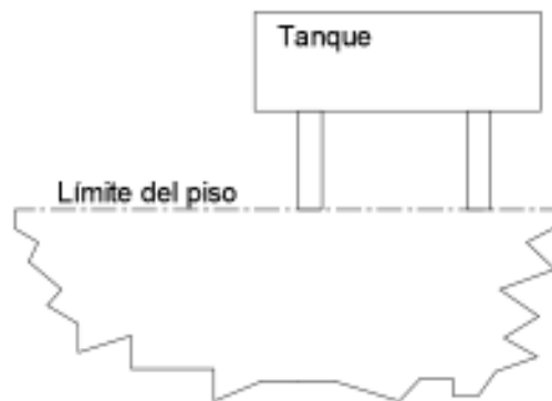
Figura 1.19. Tanque a un nivel superior al ras de piso.
