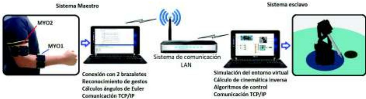
Figura 2.45. Sistema para operación remota.
