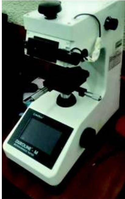
Figura 2.7. Máquina de microdurezas.
