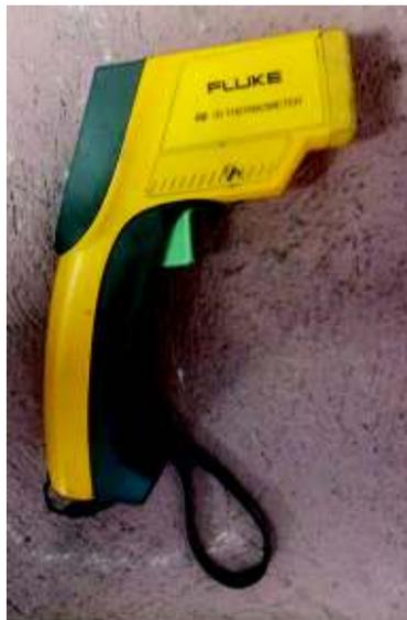
Figura 2. 12. Pirómetro infrarrojo.
