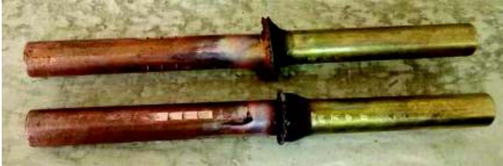
Figura 2.13. Probetas soldadas.
