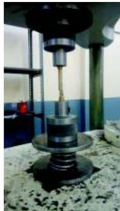
Figura 2.16. Ensayo de tracción del material base.
