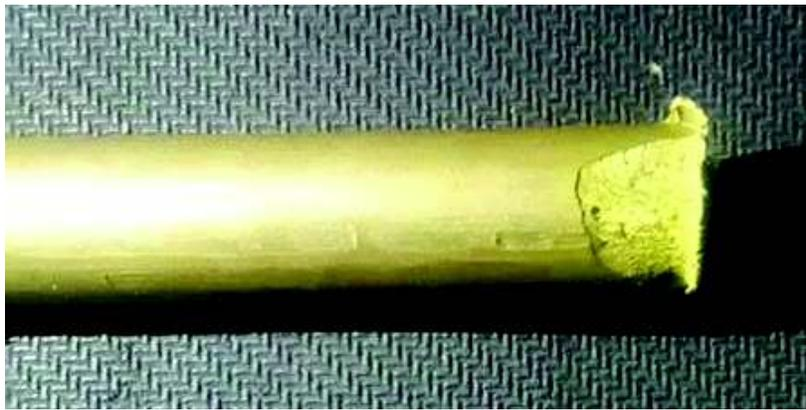
Figura 3.12. Probeta de latón fracturada.
