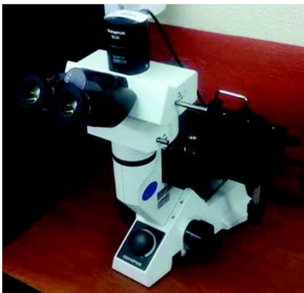
Figura 2.6. Microscopio metalográfico.
