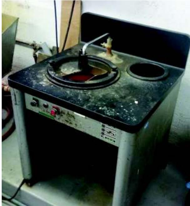
Figura 2.4. Máquina de desbaste.
