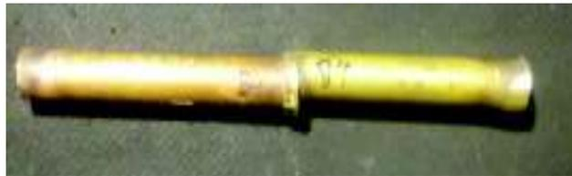
Figura 2.15. Probeta soldada.
