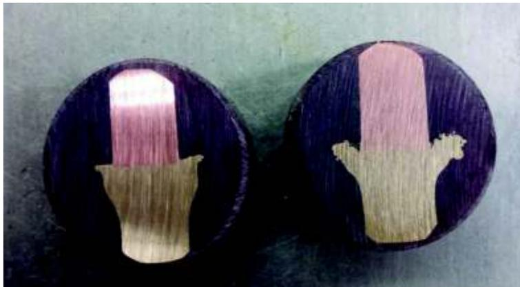
Figura 2.20. Montaje de las probetas en resina.
